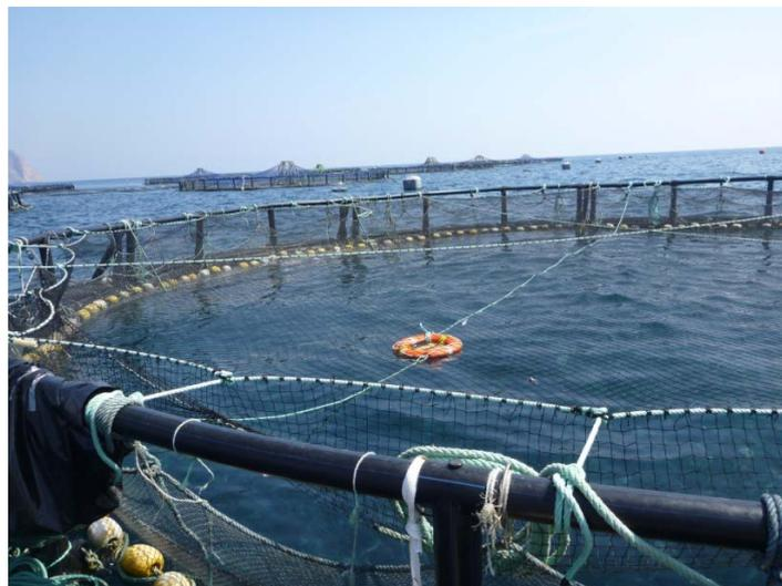
Fotografía 37. Dispositivo de Culmarex. Instalación del transductor en superficie orientado hacia el fondo para la toma de mediciones dorsales. Se sitúa a un tercio del diámetro de la jaula.
