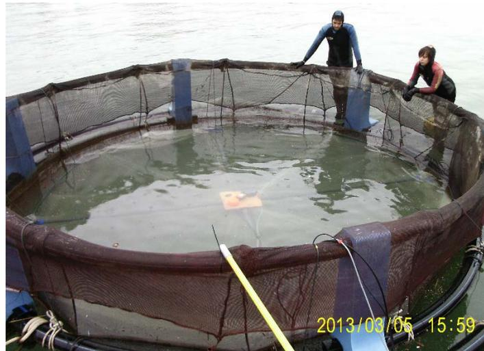
Fotografía 16. Detalle de los transductores instalados en el fondo de la estructura secundaria para la realización de mediciones ventrales. Antes de comenzar a medir es necesario sumergir la estructura secundaria hasta el fondo de la jaula.
