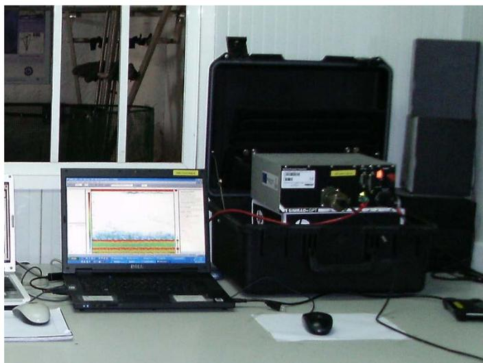
Fotografía 22. Transceptor de la ecosonda EK60 y portátil para el control y almacenado de datos.
