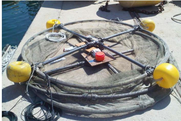
Fotografía 49. Instalación de los transductores en el fondo de la jaula.
