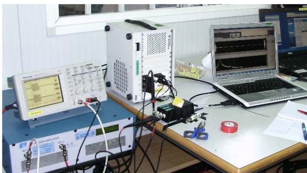
Figura 6.2. Equipo empleado para la generación del pulso transmitido y la grabación de la señal de ecos, formado por un sistema PXI portátil, un amplificador, y un ordenador.
