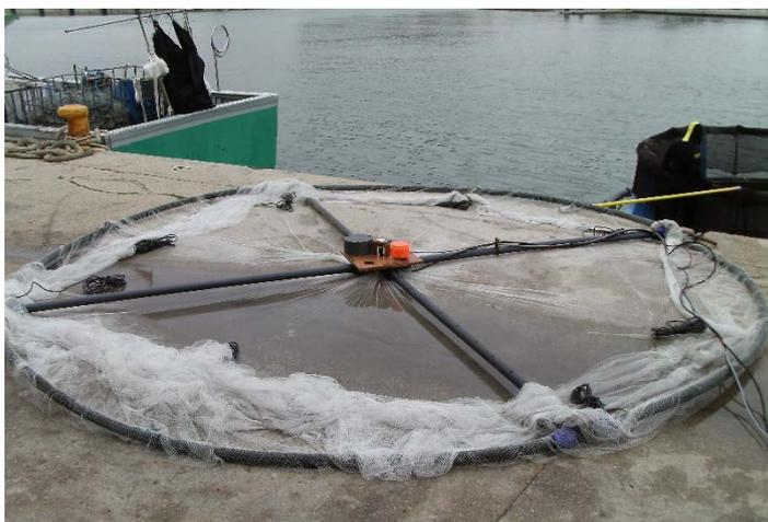
Fotografía 14. Instalación de la plataforma de los transductores en el fondo de la jaula para la realización de medidas ventrales. Se fija la plataforma a la cruceta de la estructura secundaria con bridas.
