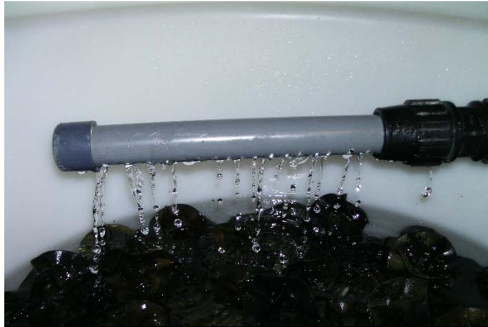
Fotografía 32. Detalle del interior del tanque de biobolas empleado para el filtrado biológico del agua de los tanques.
