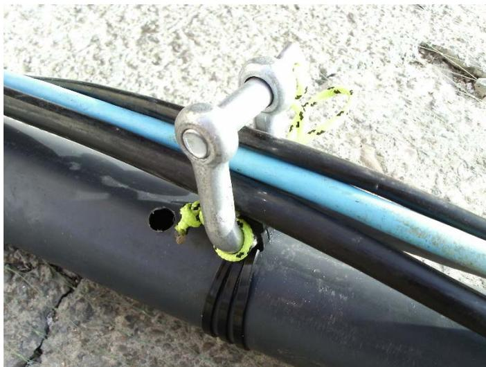
Fotografía 15. Detalle del sistema de fijación de los cables de los transductores a la estructura secundaria, para evitar la detección acústica de los cables. Se coloca un grillete a mitad de radio y otro próximo a la circunferencia, que permiten el guiado de los cables por el lateral de la jaula.
