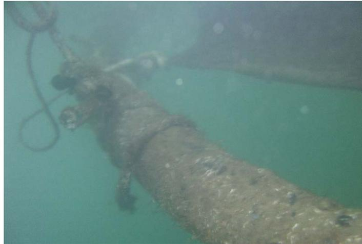
Fotografía 12. Detalle de los organismos fijados en el anillo anticorriente después de eliminar la población de mejillones.
