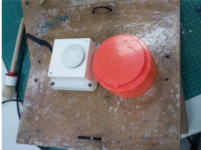
Fotografía 48. Instalación de los transductores en una plataforma de madera. El transductor 200-28 CM (blanco) se emplea para la medida de la forma de onda y el ES200-7C para la medida del *TS* junto con la EK60.
