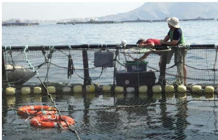
Fotografía 35. Dispositivo de Culmarex. Instalación de la ecosonda en la barandilla de la jaula y de las baterías sobre los anillos de flotación.
