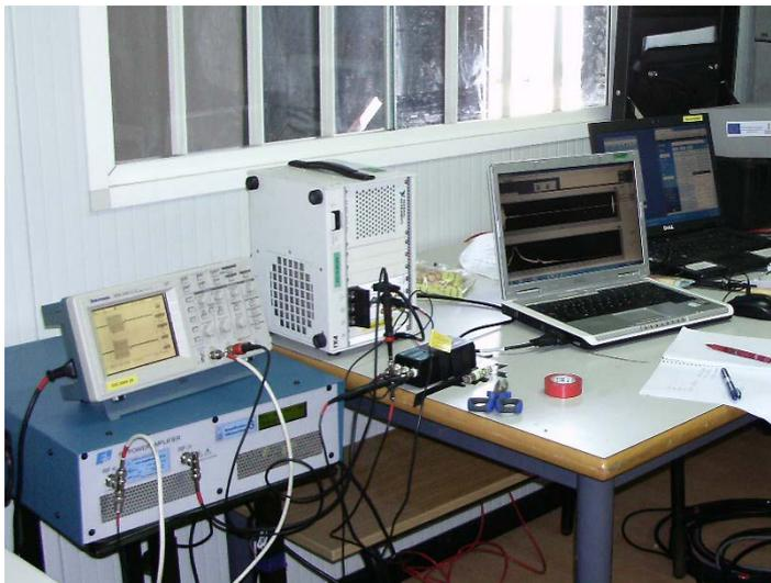
Fotografía 51. Sistema PXI portátil de generación y adquisición de señales, amplificador y ordenador de control.
