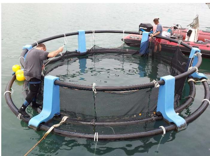
Fotografía 3. Montaje de la jaula experimental, paso 3. Se amarra la parte superior de la red a la barandilla.
