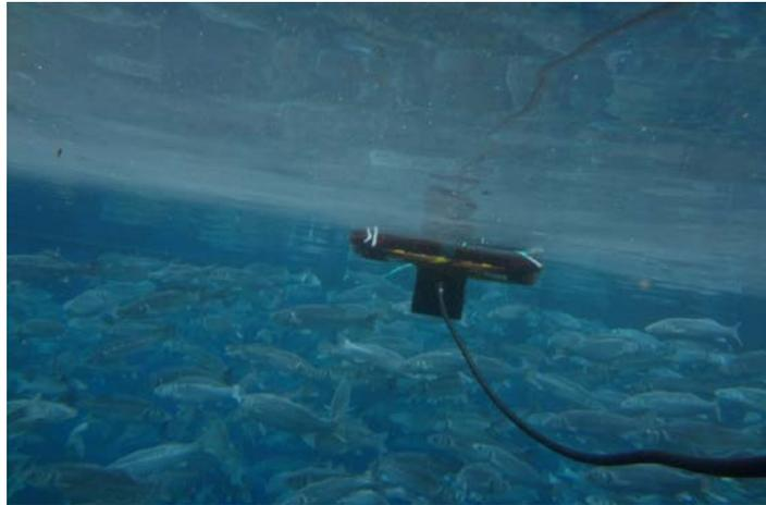
Fotografía 38. Dispositivo de Culmarex. Detalle del transductor sumergido y del cardumen de lubina en el interior de la jaula.
