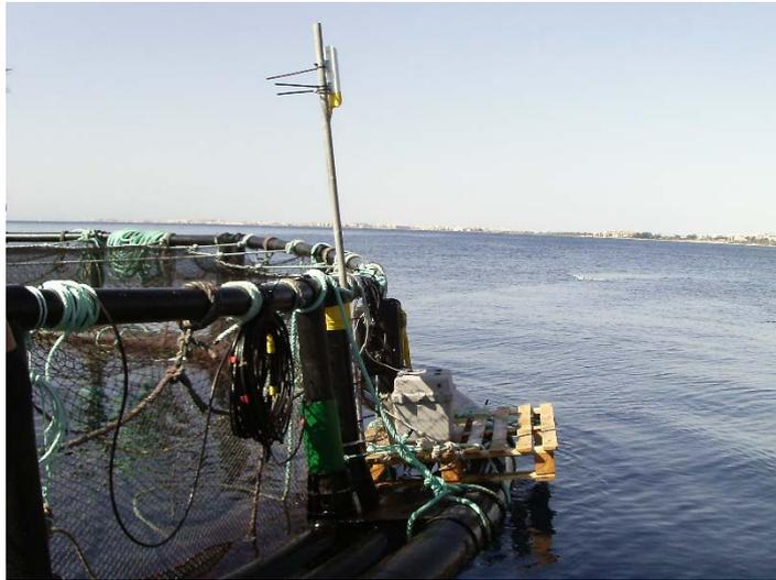
Fotografía 40. Dispositivo de Piagua. Se asegura el cable del transductor a la barandilla.
