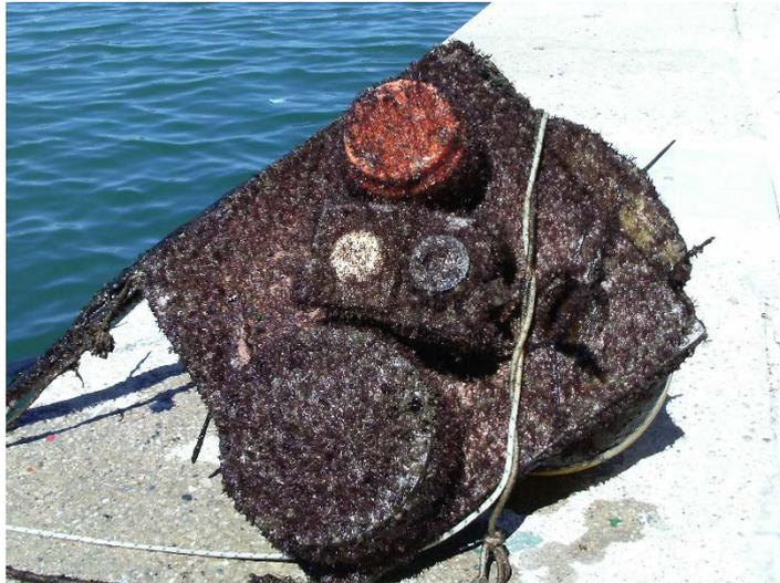
Fotografía 24. Plataforma con los transductores a finales del mes de julio de 2013 con una gran cantidad de organismos adheridos debido a las altas temperaturas del agua.
