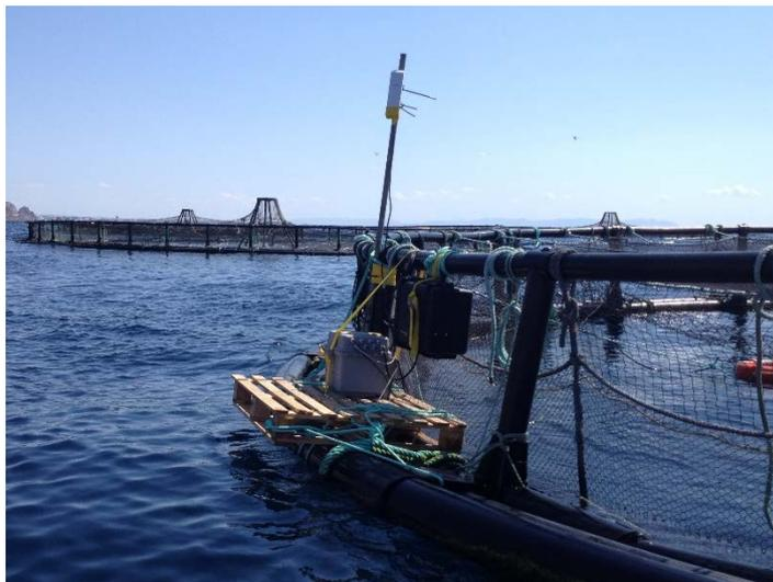
Fotografía 39. Dispositivo de Piagua. Instalación de la ecosonda en la barandilla de la jaula, la caja de baterías sobre los anillos de flotación, y de la antena wifi en un mástil fijado al candelero próximo a la ecosonda.
