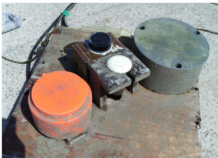
Fotografía 23. Plataforma con los diferentes transductores utilizados para las mediciones acústicas.
