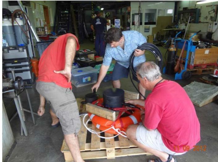
Fotografía 36. Dispositivo de Culmarex. Montaje del transductor sobre una plataforma de madera anclada a un flotador salvavidas que le proporciona flotabilidad para la realización de mediciones dorsales.
