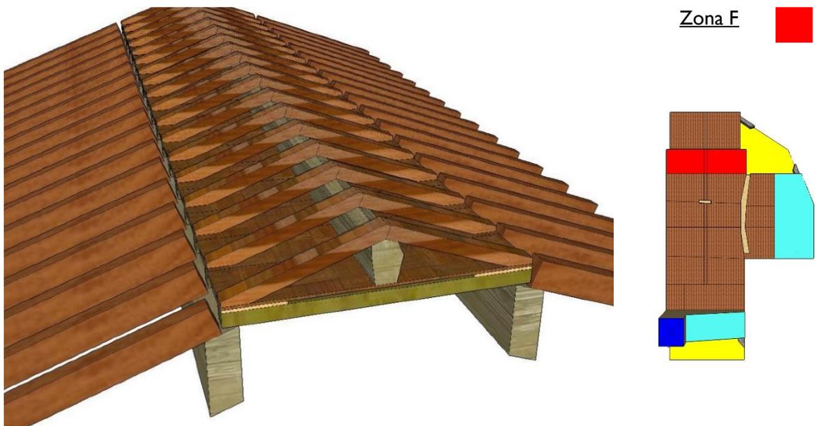
Meseta con viga central en cumbra y con remate de cabios a diferente posición, siendo los localizados en la zona más oeste de mayor longitud (tablas no representadas).
