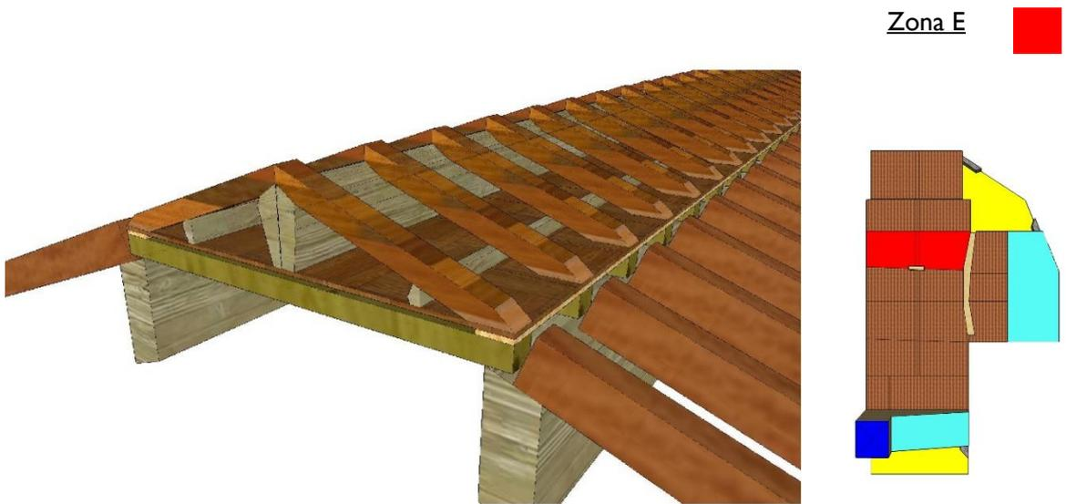
Meseta con doble viga en cumbra, vigas de menor espesor sobre zona tablas horizontales y con remate a igual posición de cabios (tablas no representadas).
