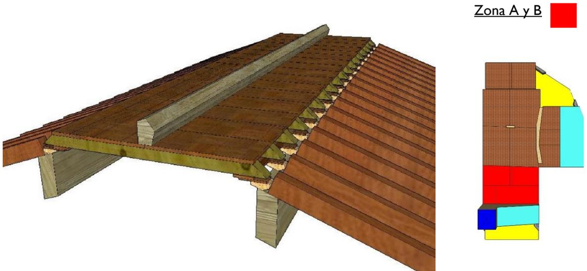
Al determinar el sistema constructivo le faltaban los cabios, no obstante en la imagen podemos observar el despiece de este tipo de meseta (tablas no representadas).
