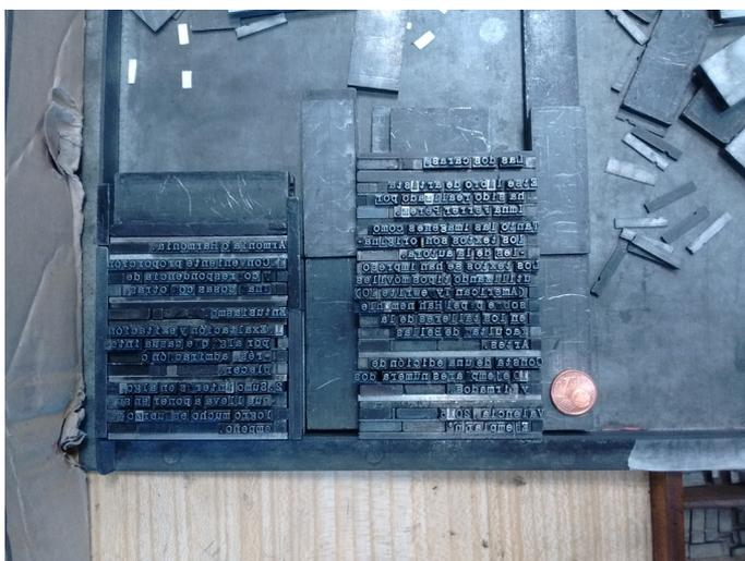
Fig. 42: Textos compuestos en la bandeja esperando a ser impresos.
