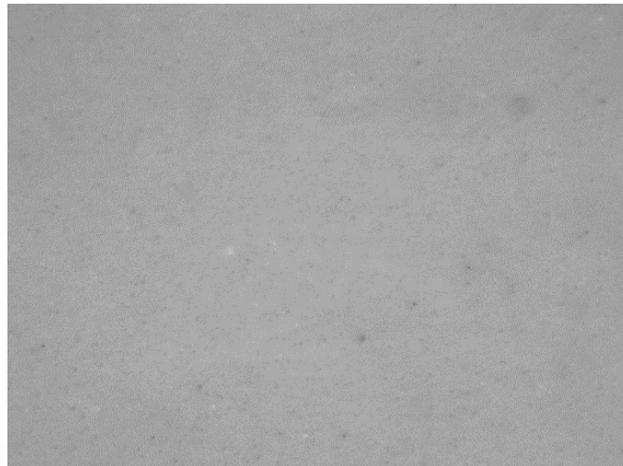
**Figura 128.- Aspecto morfológico del adhesivo de poliuretano de la unión adhesiva PP/PP sin pretratamiento de plasma atmosférico. Rotura de tipo adhesivo (50X).**
