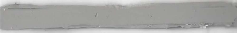
**Figura 123.- Macroscopía de la superficie de la muestra PP/PP tras el ensayo de pelado en T, sin pretratamiento de plasma atmosférico.**
