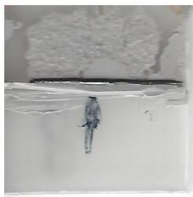
**Figura 127.- Macroscopía de la superficie de la muestra PP/PP tras el ensayo de cizalla, con pretratamiento de plasma atmosférico (atmósfera de aire, distancia tobera/sustrato 6 mm y 300 mm/s de velocidad de pasada).**
