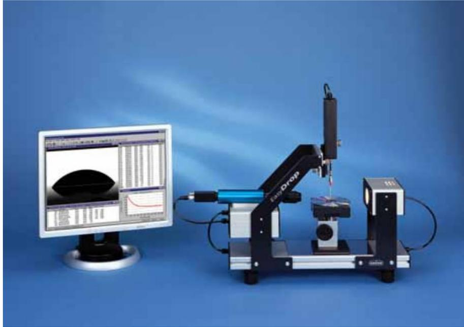
**Figura 26.- Goniómetro óptico EASYDROP STANDARD.**
