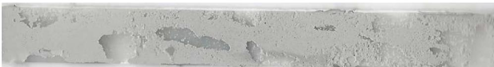
**Figura 125.- Macroscopía de la superficie de la muestra PP/PP tras el ensayo de pelado en T, con tratamiento de plasma atmosférico (atmósfera de aire, distancia tobera/sustrato 14 mm y 700 mm/s de velocidad de pasada).**
