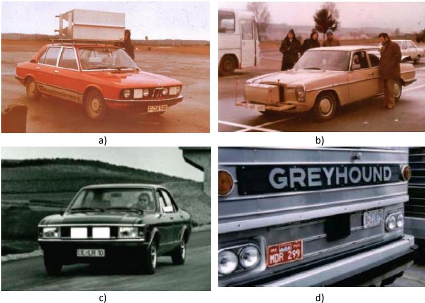
Figura 2.9 Primeros prototipos de radares vehiculares. a) Radar a 10 GHz construido por VDO a principios de los años 70, b) Radar a 16 GHz construido por SEL en 1975, c) Radar a 35 GHz construido por AEG-Telefunken en 1974, d) Radar a 24 GHz construido por EATON-VORAD en 1996.
