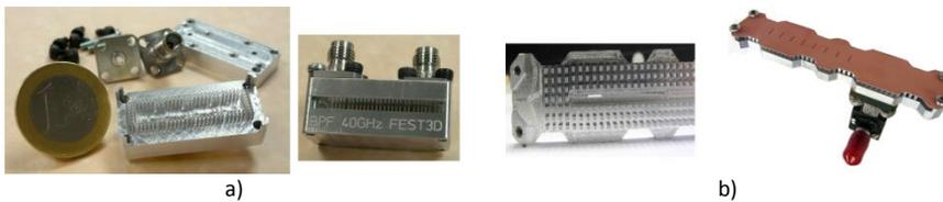
Figura 3.18 Prototipos de dispositivos con guías GGW a) Filtro paso banda a 40 GHz, b) Agrupación de antenas de 8x1 elementos.
