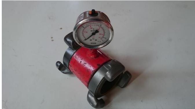
*Imagen 3.16 - Pesatomas de 45 mm con manómetro Bourdon*
