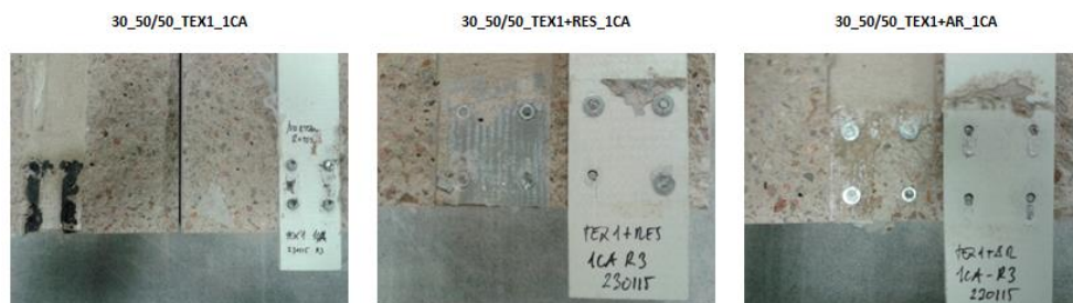
Fig. 6.31 Roturas interfase GFRP-hormigón, modalidad ICA, con tornillería sin desplazamiento, M4 6.6.
