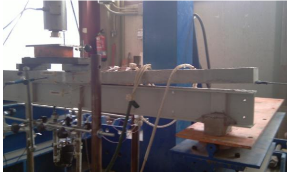
Fig. A1.20 Rotura a flexión 4 puntos de la viga híbrida HYB_HRF_60.
