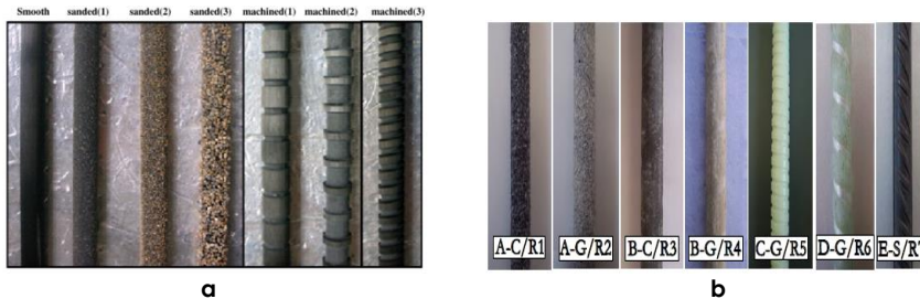
Fig. 2.41 Barras de FRP utilizadas con distintos tratamientos superficiales ( a AL-Mahmoud et al., 2007y b , Baena PhD thesis, 2010).
