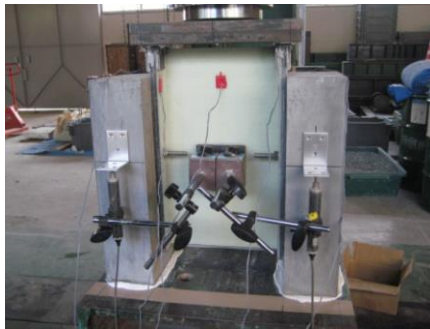
Fig. 2.37 Ensayos a cortante doble propuesto por Nguyen et al., (2014).
