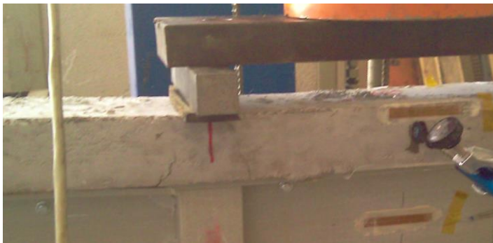
Fig. A1.26 Rotura a flexión a 4 puntos de la viga híbrida HYB_HRF_120.
