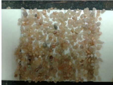
Fig. 5.8 Tratamiento interfase tipo arenado.
