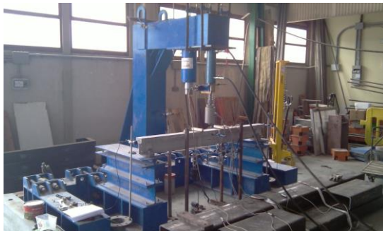
Fig. A1.6 Viga híbrida HYB_HRF_0 patrón, ensayo a flexión a 4 puntos.
