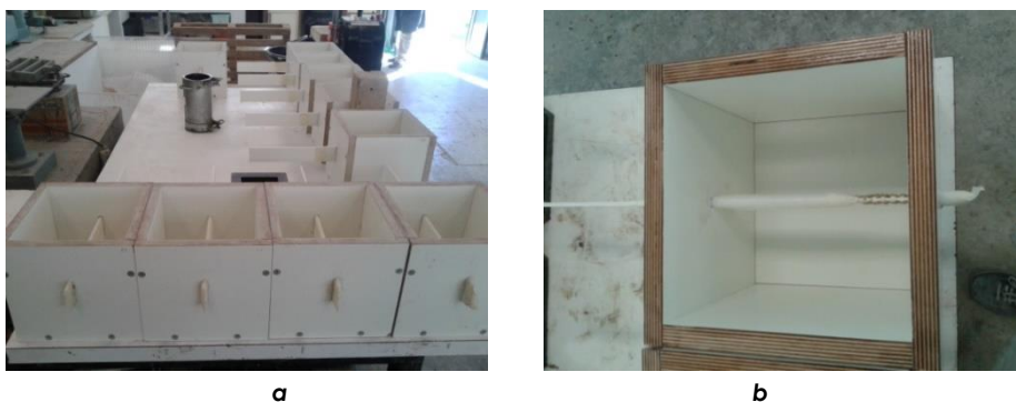
Fig. 4.6 Encofrados (a) y probeta preparada para hormigonar (b).
