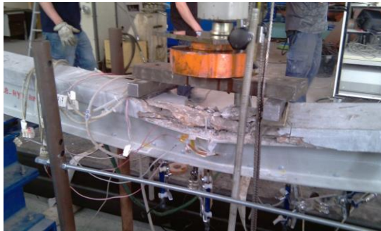
Fig. A1.10 Rotura a flexión 4 puntos de la viga híbrida HYB_HRF_0 patrón.
