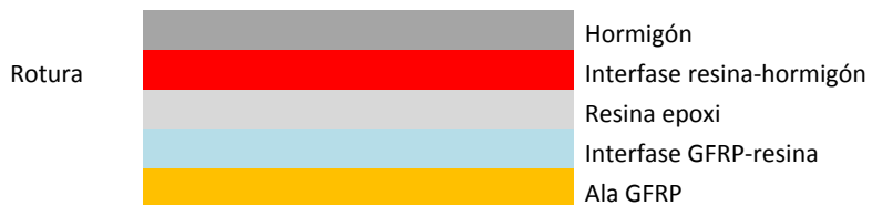
Fig. A1.11 Esquema interfase GFRP-hormigón.
