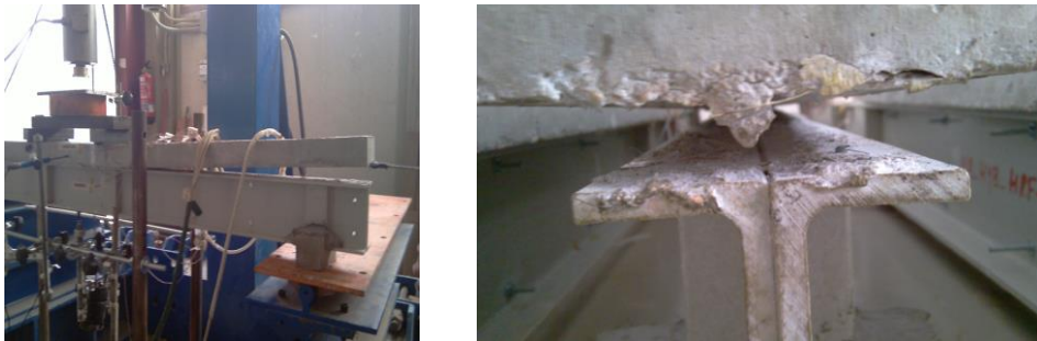
Fig. 1.3 Vista general y detalle del ensayo de viga híbrida con fallo en la unión. Anexo 1.
