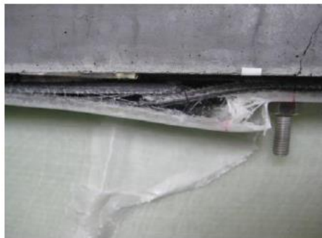
Fig. 2.21 Cortante y alabeo en el ala comprimida (Mutsuyoshi et al., 2010).
