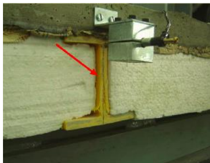
Fig. 2.12 Perfil en I, rotura alma por cortante (Barros y Lebre, 2010).
