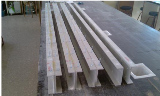
Fig. A1.3 4 Vigas de 2 UPN de GFRP pultrusionados unidos a tope, sin capa de compresión.
