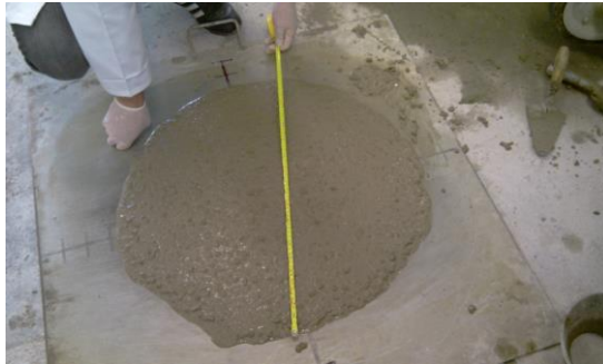
Fig. 3.3 Medición del escurrimiento y el T_{50} del hormigón.
