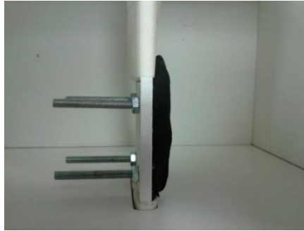
Fig. 5.15 Tornillería sin desplazamiento (TEX1) a una cara, 1CA, perfil. La plastilina es el material de color negro.
