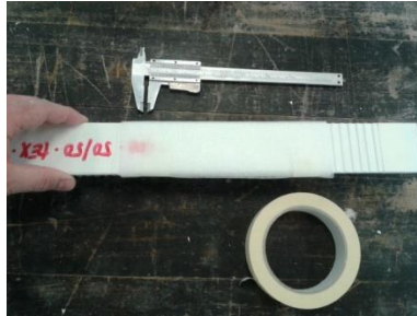
Fig. 5.2 Espuma de polietileno en la zona del perfil y cinta de carroceros.
