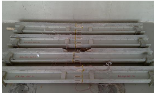
Fig. A1.28 Recuperación de la flecha tras descarga después de ensayo a flexión a 4 puntos de las vigas híbridas.
