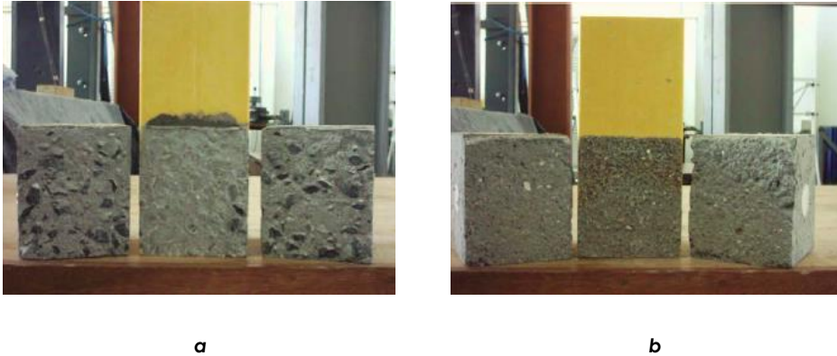
Fig. 2.13 Modo de fallo en la interfase (a) con resina epoxi en mortero (Sikadur 31) y (b) en gel (Sikadur 32) con un arenado (Barros y Lebre, 2010).
