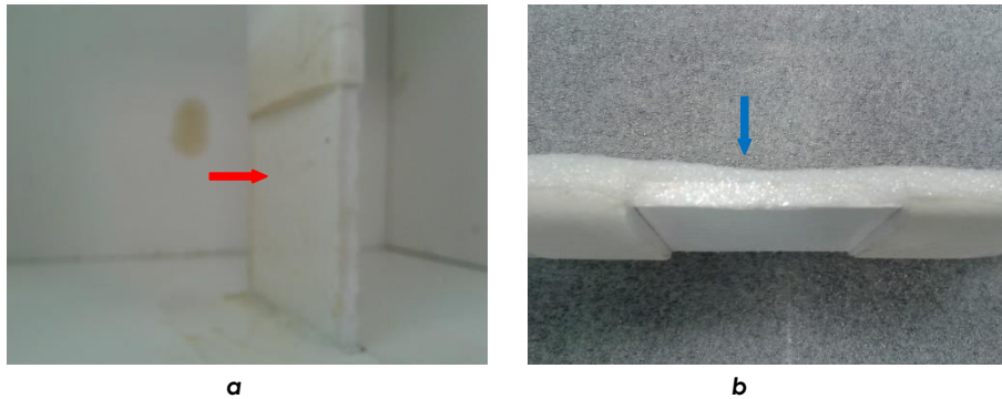
Fig. 5.4 Fotografía zona "B" y superficies sin adherencia en la zona "B" de 1CA (a) y 1CE (b).
