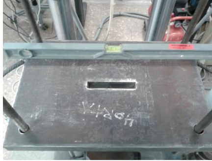
Fig. 4.9 Placa de acero S235 JR de 400 x 600 x 50 mm.
