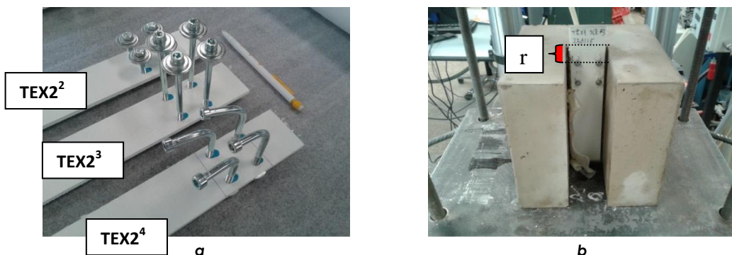
Fig. 3.2 (a) tipología tornillería TEX2 2 , TEX2 3 , TEX2 4 y (b) ubicación del recubrimiento "r" en la modalidad 1CL.
