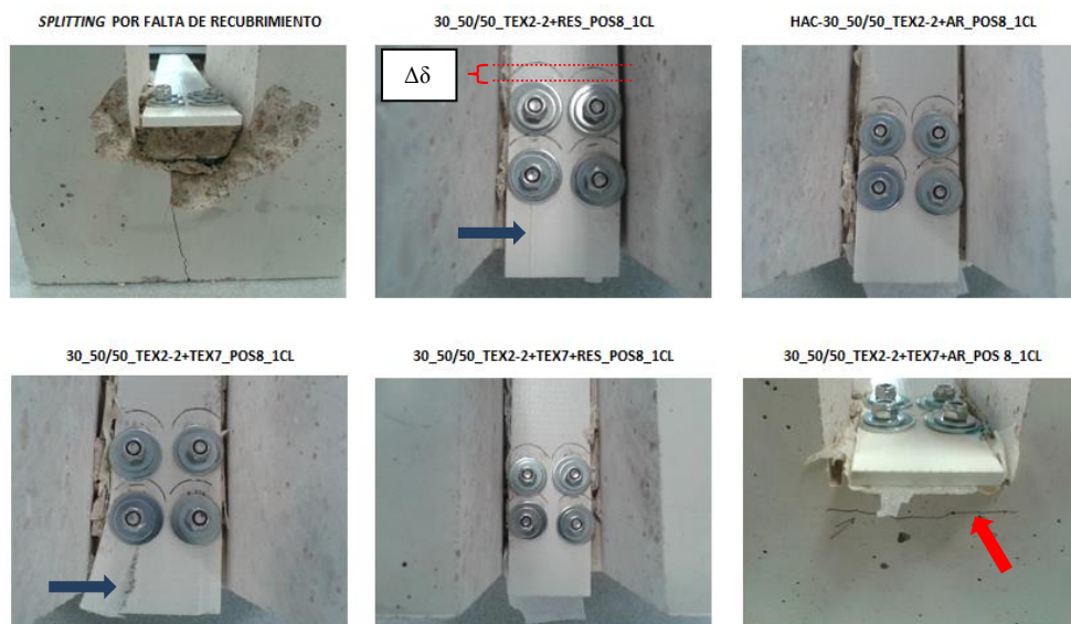
Fig. 6.43 Rotura probetas híbridas TEX2-2+ combinaciones, modalidad 1CL, tornillería con desplazamiento M6 8.8, par 8 Nm.
