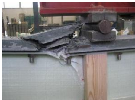
Fig. 2.23 Aplastamiento del hormigón por esfuerzos normales (Mutsuyoshi et al. , 2010).
