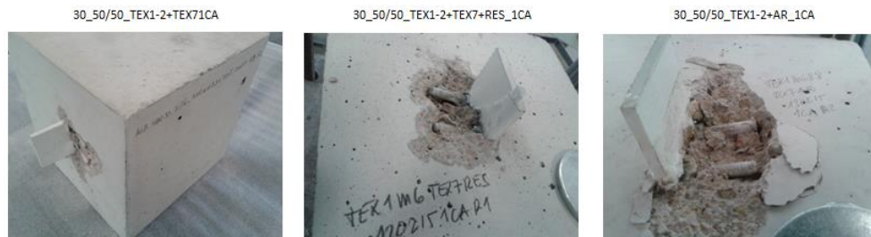
Fig. 6.36 Rotura probetas híbridas TEX1-2+texturizado 7+combinaciones, modalidad 1CA, tornillería sin desplazamiento M6 8.8.
