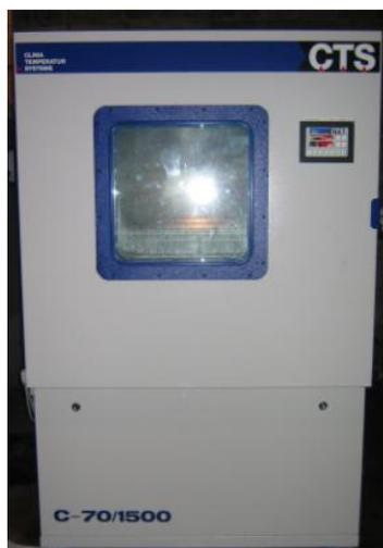
**Figura 17.** Cámara climática CTS modelo C-70/1500 empleada para el envejecimiento de los films
