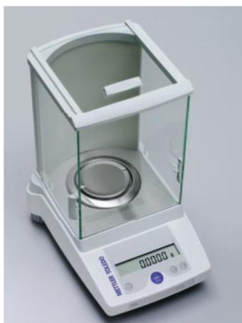
**Figura 24.** Balanza analítica empleada para determinar la variación de peso de las muestras de PP tratadas con plasma.
