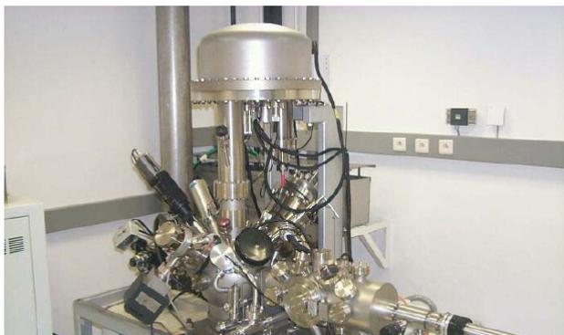
**Figura 18.** Equipo XPS VG-Microtech Multilab.
