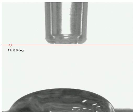
**Figura 22.** Imagen tomada por la cámara del goniómetro. Gota sobre la superficie del film
