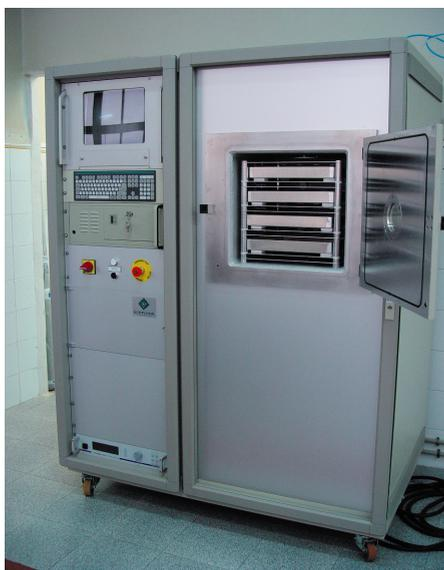
**Figura 16.** Equipo de plasma de baja presión Modelo CD400 MC option PC, de Europlasma.
