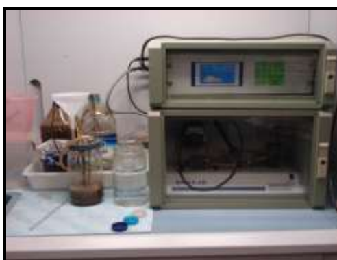
Figura 4.2.8 Respirómetro de laboratorio BM3-LAB
