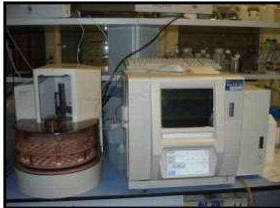
Figura 4.2.4 Analizador de Carbono Orgánico Total (COT)
