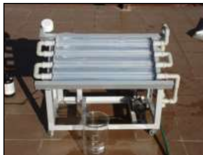
Figura 4.3.3 Planta piloto de fotocatalisis solar de 4 L.
