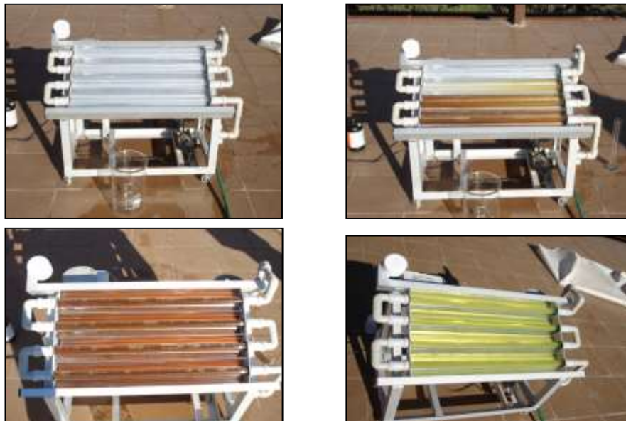
Figuras 5.3.13 Seguimiento del tratamiento con peróxido de hidrógeno de aguas cianuradas en la planta solar piloto de 4 litros.
