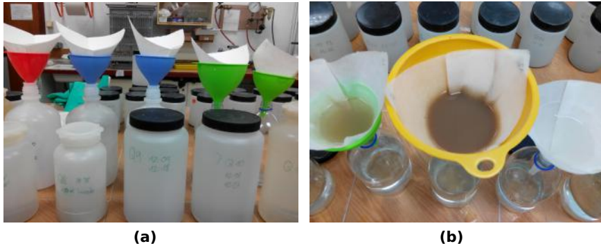
Figura 3.14: Filtrado del agua de escorrentía: (a) Preparación de los filtros; (b) Filtrado del agua de los recipientes
