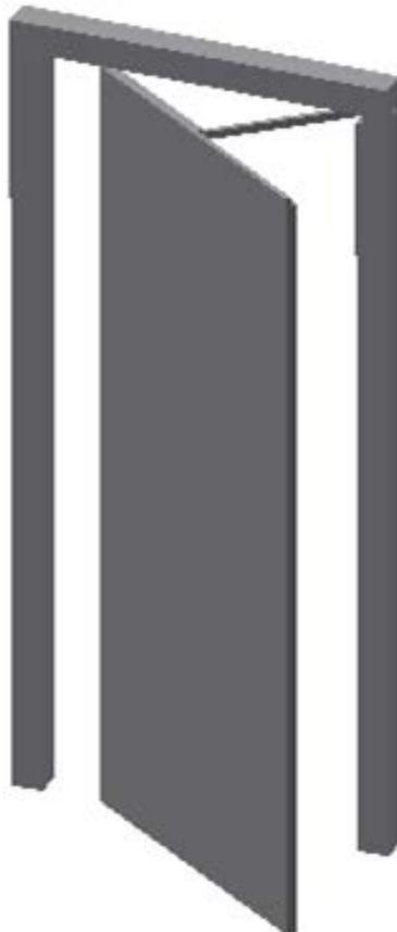
Para el funcionamiento de éste sistema se ha utilizado una barra abatible, que se adentra en una cavidad realizada en la puerta, y una guía incrustada en la parte superior, donde un mecanismo unirá la puerta con ésta, permitiendo un doble movimiento, de giro y de desplazamiento lineal.
