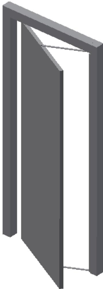
El Diseño 3 continúa con el mismo método de utilización de una guía con movimiento de giro y de traslación, y de una barra como pivote, aunque al contrario que en el Diseño 1, se utilizan dos barras, una superior y una inferior.
