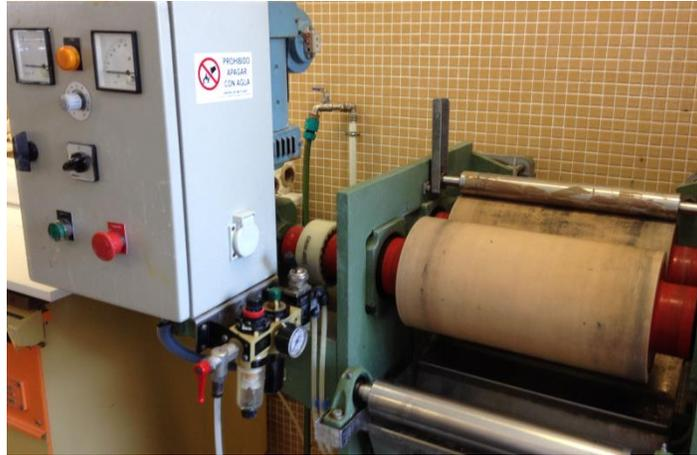
**Imagen 8.10** Mecanismo de impregnación *Foulard horizontal TEPA2608*
