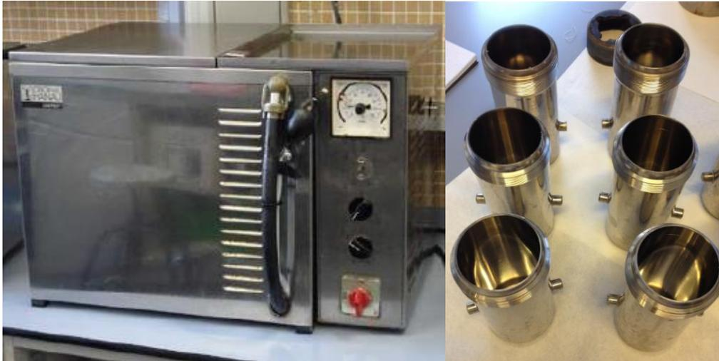
**Imagen 8.7** Dispositivo mecánico de lavado *Linitest* y contenedores de acero inoxidable
