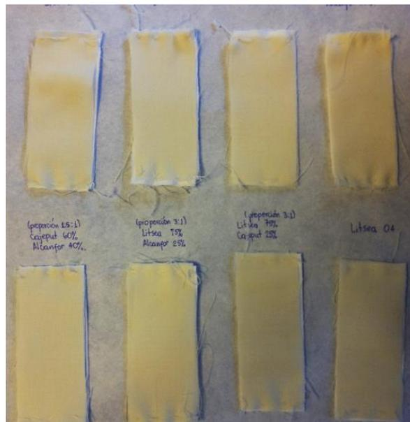
**Imagen 8.8** Ensamblaje triple lana-probeta-algodón
