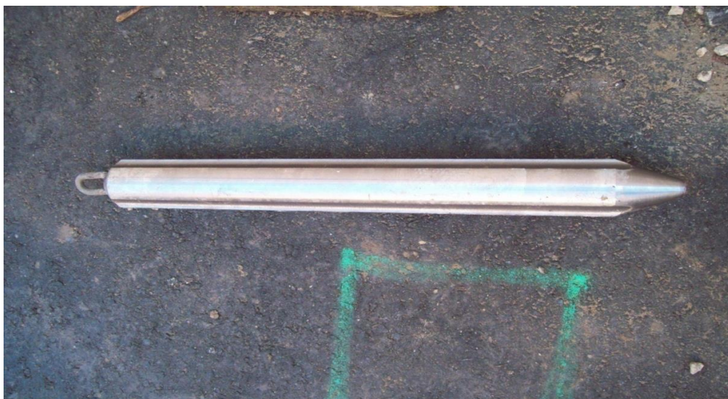
Ilustración 3.7. Fotografía del peso que se acopla a la sonda.
