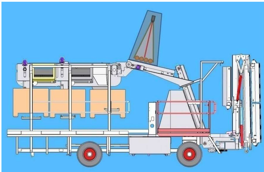
Figura 6.19b. Máquina con la cámara orientada verticalmente
