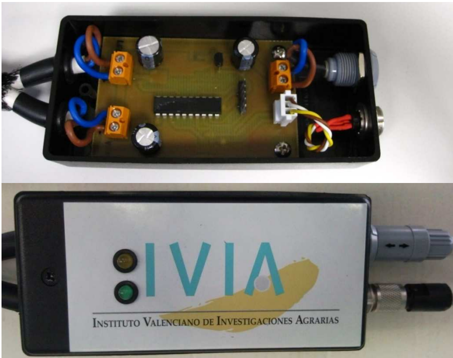
Figura 6.13. Control de la iluminación estroboscópica
