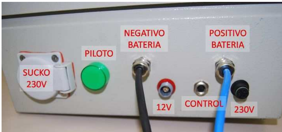
Figura 8.4. Conexiones del cuadro de alimentación
