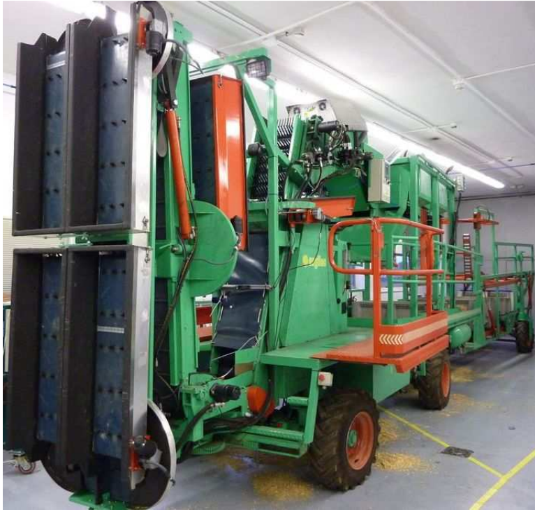
Figura 6.1. Plataforma de recolección de cítricos
