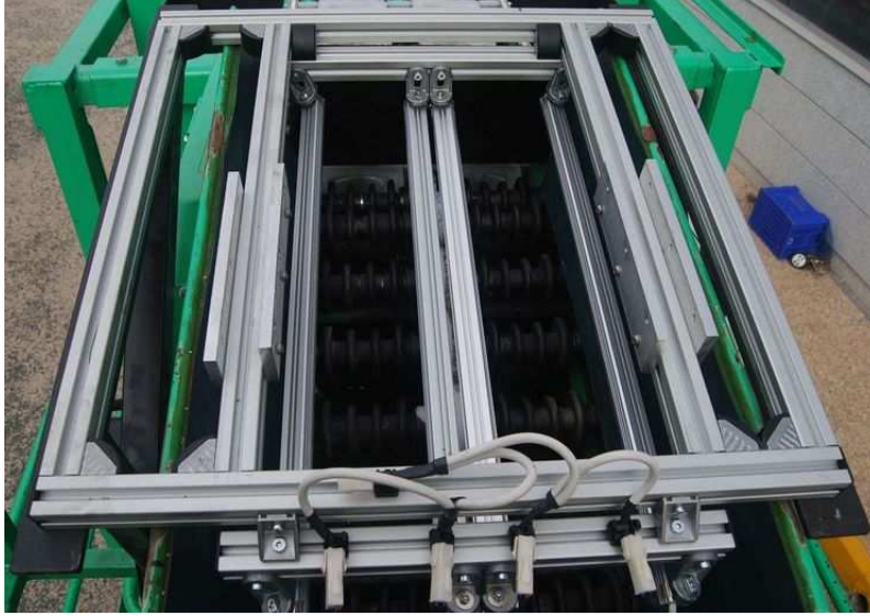
Figura 6.16b. Estructura de soporte de las lámparas
