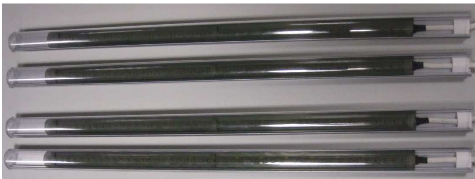
Figura 6.15a. Tiras de LEDs con los filtros polarizadores integrados
