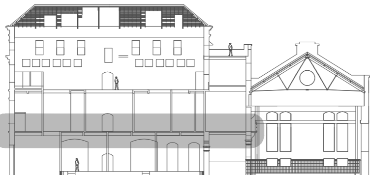
LEYENDA Fig. 1_Muro de carga Fig. 2_Forjado unidireccional de hormigón armado Fig. 3_Muro de carga Fig. 4_Hueco instalaciones Fig. 5 y 5'_Escalera' Losa de hormigón y peldaños de ladrillo cerámico Fig. 6_Losa HA Fig. 6'_Muro de carga Fig. 7_Muro de carga Fig. 8_Doble viga HA Fig. 9_Muro de carga de 75cm Fig. 9'_Muro de carga de 25cm Fig. 10_Forjado bidireccional Fig. 11_Lucernario Fig. 13_Muro de carga apoyo grúa puente Fig. 14_Pilastro Fig. 16_Viga intermedia Fig. 17_Voladizo losa HA Fig. 18_Pilar HA Fig. 12_Pilar HA y armadura metálica existente
