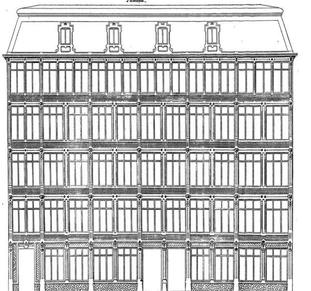
Fábrica de Harinas "La Ceres" - Bilbao - Hormigón Armado Hennebique Sistema Privilegiado - Fachada.
