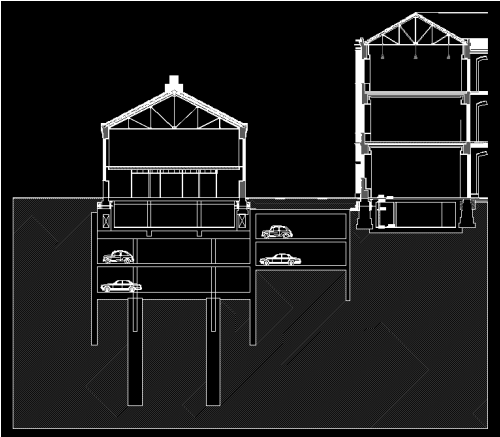
Proceso de Ejecución de la Cimentación de Nave Norte. Sistema descendente-ascendente
