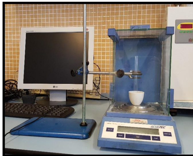
Figura IV.23 Equipo empleado para la medición de absorción de agua del residuo de café.
