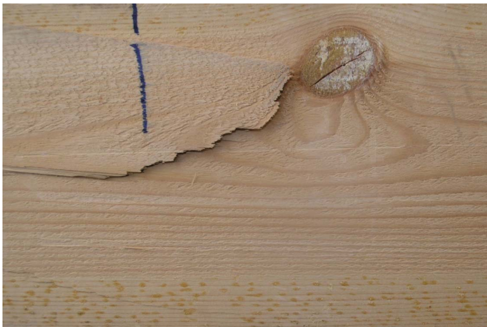
Figura 100. Detalle de rotura por nudo de la viga PS2-36.
