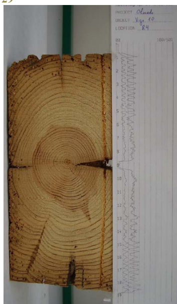
Fig. 29. Resistograma de madera de P. sylvestris .
