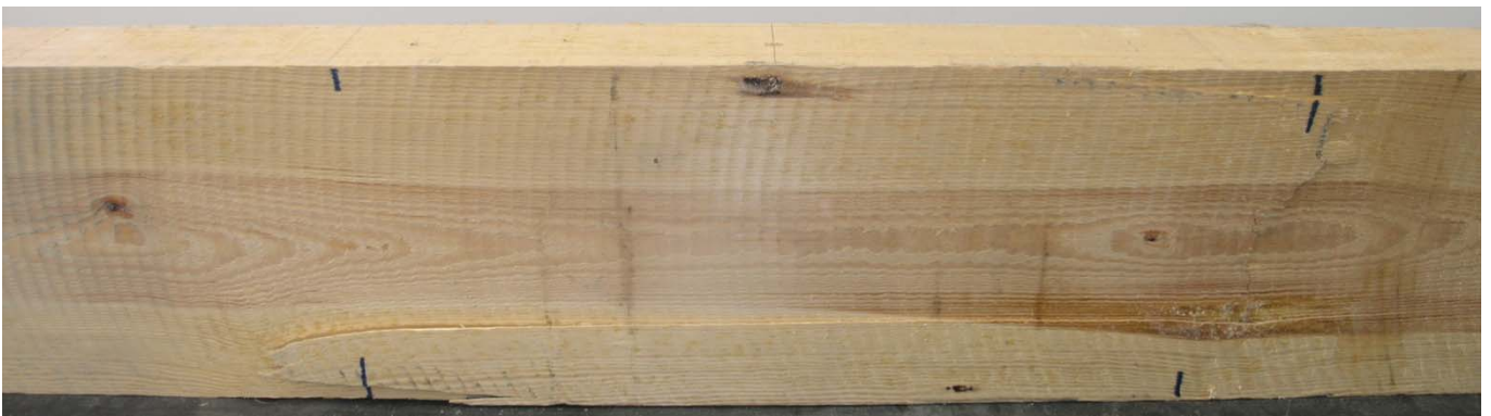
Figura 77. Detalle de rotura de la viga PS1-7, por una zona sin imperfecciones en superficie.
