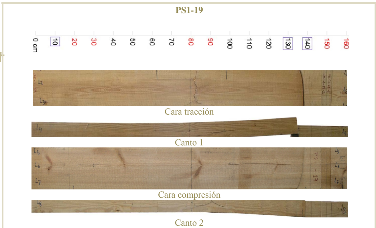
Figura 56. Imágenes de los alzados correspondientes a cada una de las caras de la pieza de madera PS1-19.
