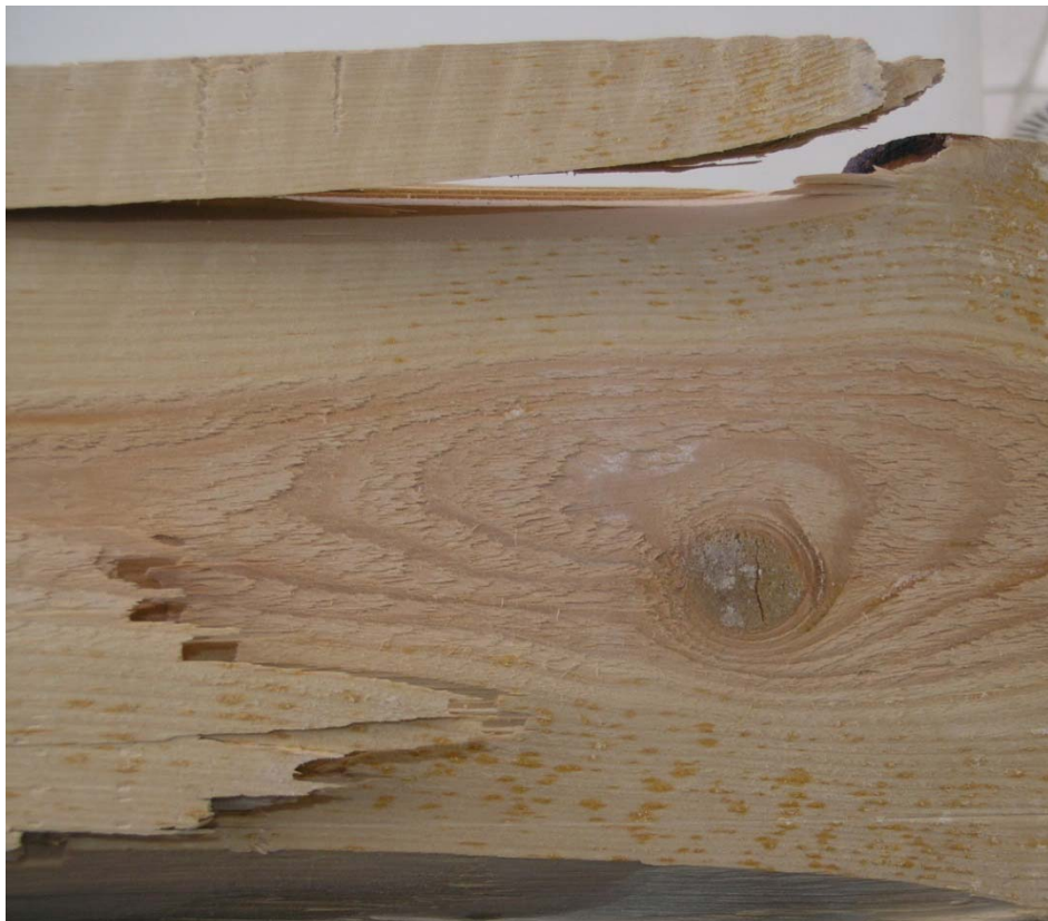
Figura 99. Detalle de rotura por nudo de canto la viga PS2-32.
