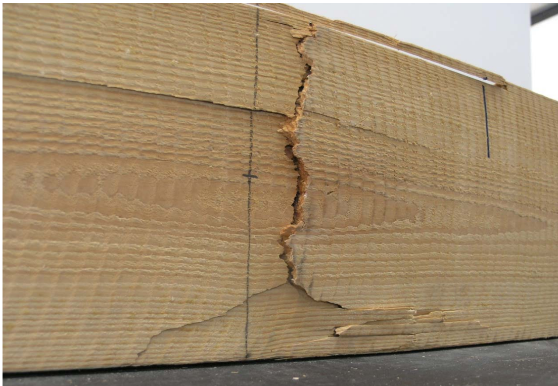
Figura 80. Detalle de la rotura de la viga PS1-19, por una zona libre de imperfecciones en superficie.
