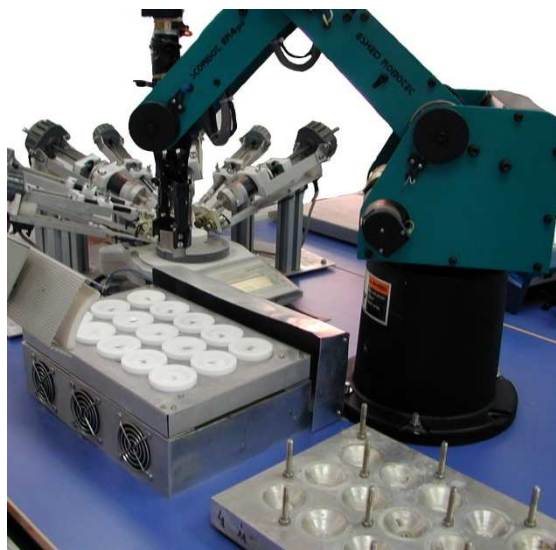
Figura 1.17. Sistema robotizado diseñado en el ITQ [182] para la síntesis de zeolitas.
