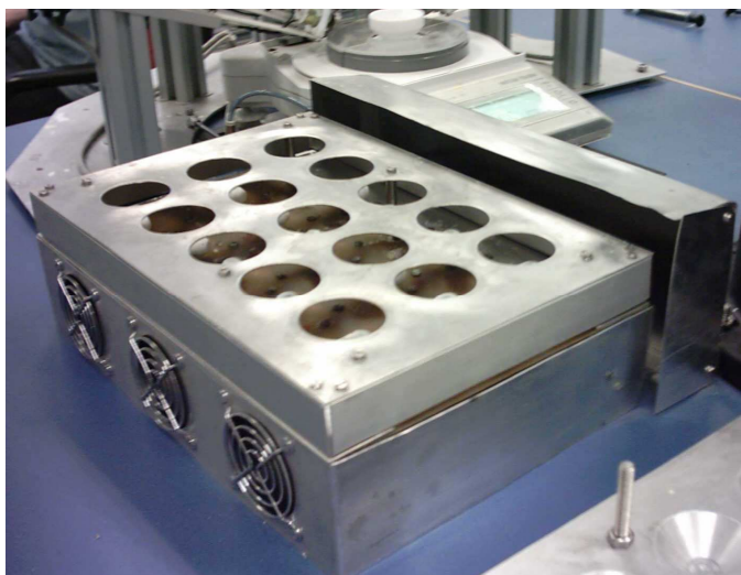
Figura 3.3. Estación de agitación/evaporación.
