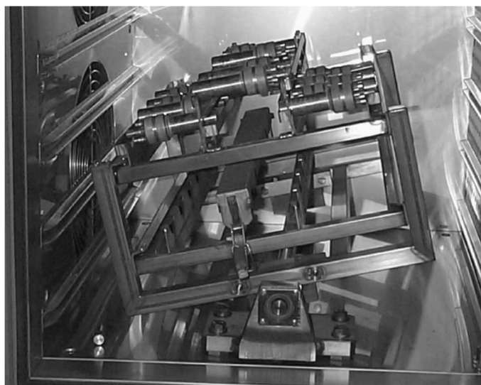
Figura 1.15. Dispositivo multiautoclave diseñado por Tagliabue [180] y utilizado durante la síntesis de zeolitas.
