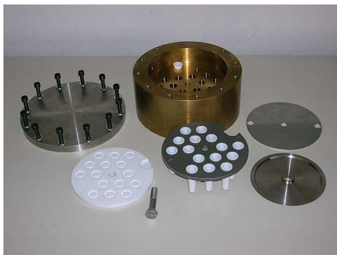
Figura 1.16. Multiautoclave diseñado por Caremans [181] con capacidad para albergar 15 mezclas de reacción.
