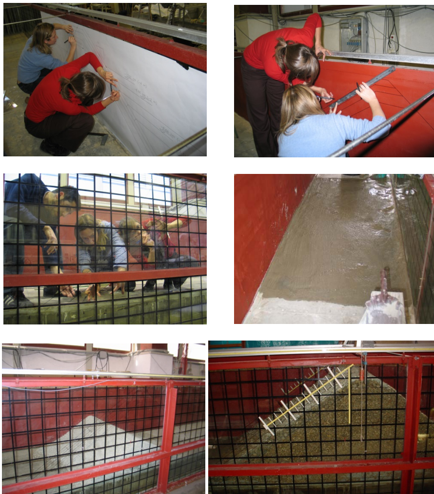
Figura IV.4. Dibujo de la sección en las paredes del canal, vertido de la lechada de cemento y construcción de núcleo y filtro del modelo de cubos y Cubípodos en el canal de oleaje del LPC-UPV.
