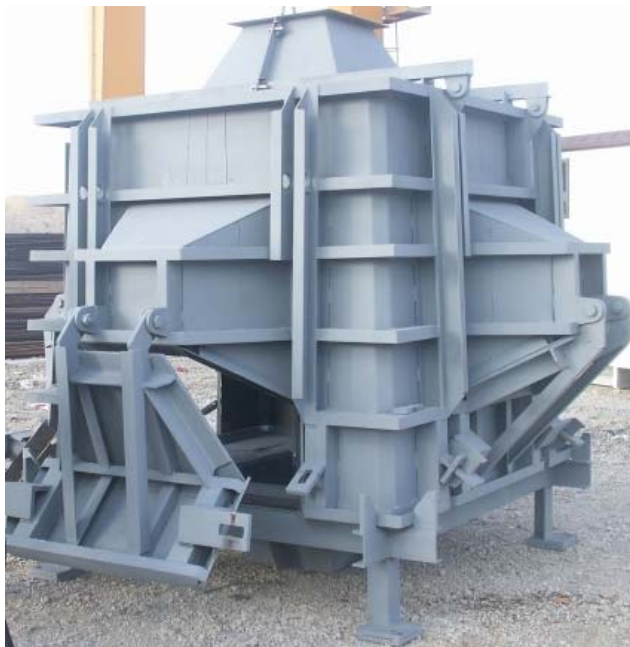
Figura II.15. Encofrado del Cubípodo de 16t.
