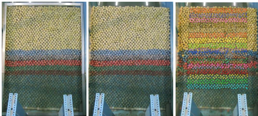
Figura IV.20. Fotografías perpendiculares al talud con marco de referencia, sin marco y con Malla Virtual y conteo de unidades.
