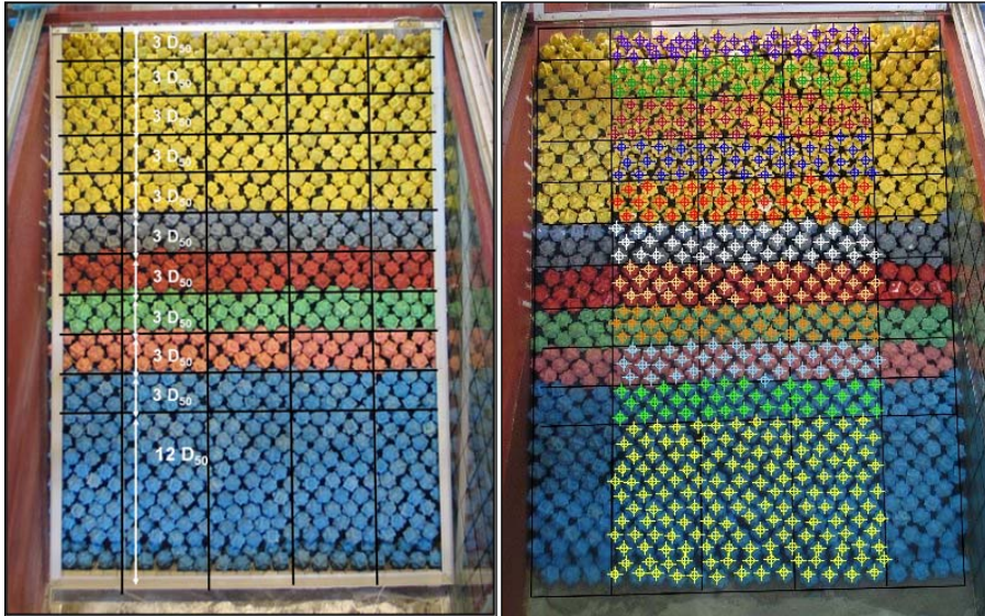
Figura IV.22. Fotografías perpendiculares al talud del manto bicapa de Cubípodos: (1) con marco de referencia y Malla Virtual, y (2) sin marco de referencia, con Malla Virtual y conteo de unidades en cada banda ( N_i ).
