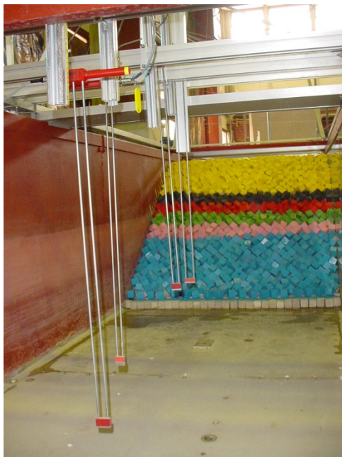
Figura IV.8. Sensores de capacidad colocados en la zona del modelo de cubos.
