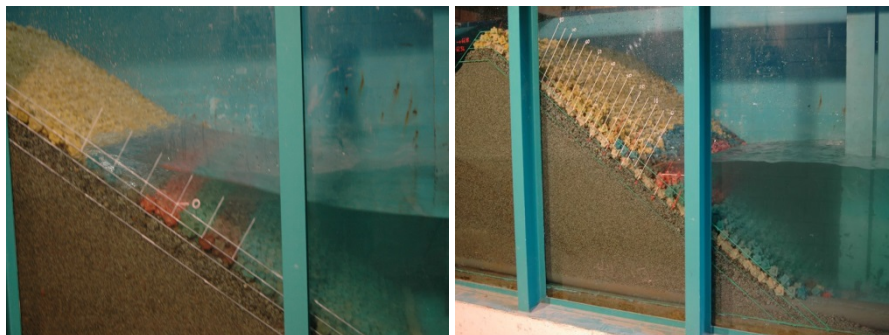
Figura IV.18. Vista lateral de los modelos de Cubípodos monocapa y bicapa construidos en INHA.
