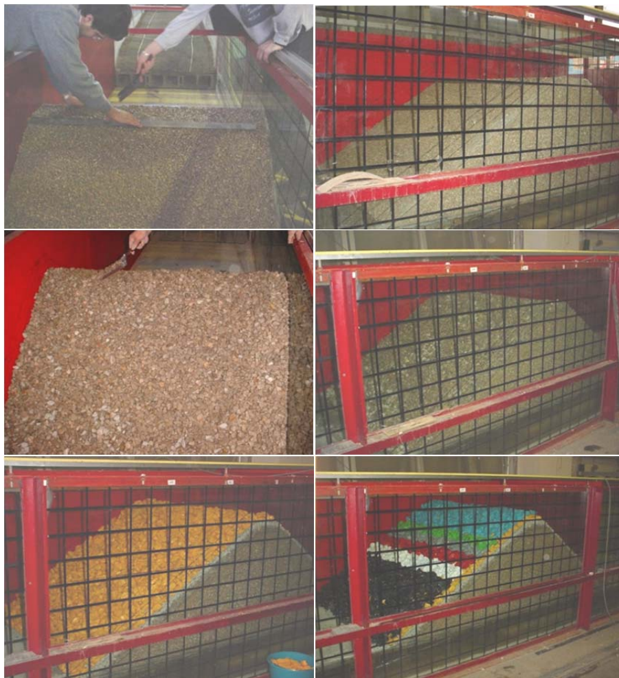
Figura III.5. Proceso de construcción del dique de escollera natural.
