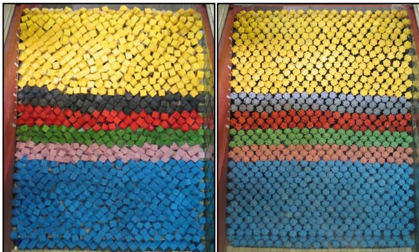
Figura IV.6. Vista superior del manto principal de cubos y Cubípodos.
