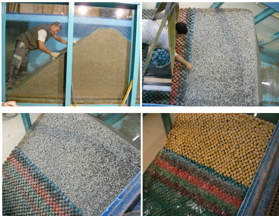
Figura IV.16. Construcción del modelo de Cubípodos monocapa construido en INHA.
