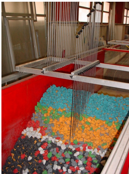
Figura III.8. Perfilador mecánico obteniendo el perfil central del talud.
