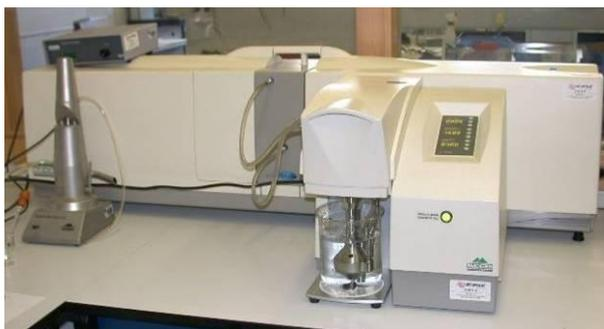
**Figura 4.13. Equipo de determinación de granulometría por el Método Coulter**
