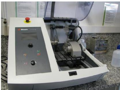
**Figura 4.34. Imagen de la cortadora de precisión Secotom 1-5 de Struers**
