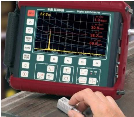
**Figura 4.18. Equipo de ultrasonidos empleado para la determinación del módulo elástico.**
