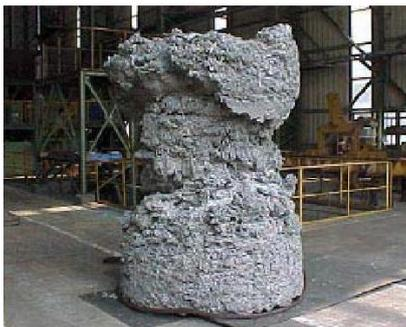
**Figura 2.37. Esponja de titanio obtenida mediante el método Kroll, antes del proceso de troceado (Toho-Titanium)**
