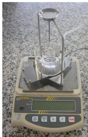
Figura 4.15. Esquema del montaje para el Método de Arquímedes
