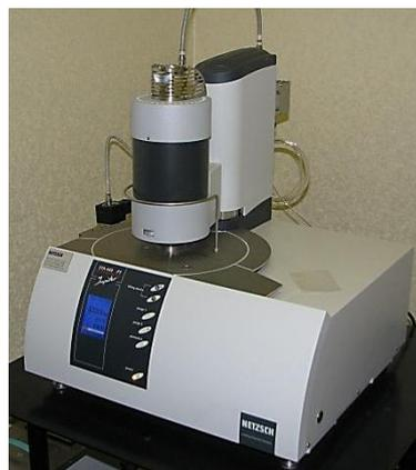
Figura 4.36. TG-DSC modelo NETZSCH STA 449 F3.
