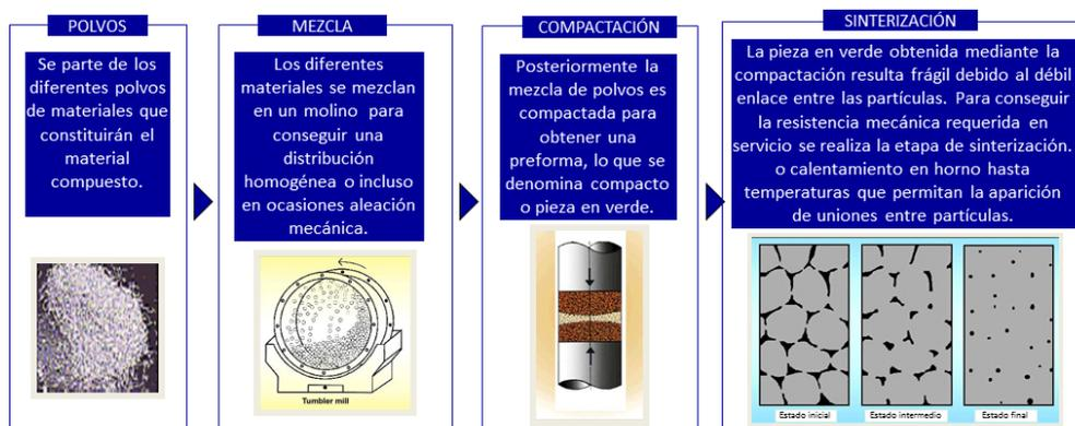
Figura 2.33. Secuencia de fabricación para MMCs reforzados por partículas por vía pulvimetalúrgica convencional.
