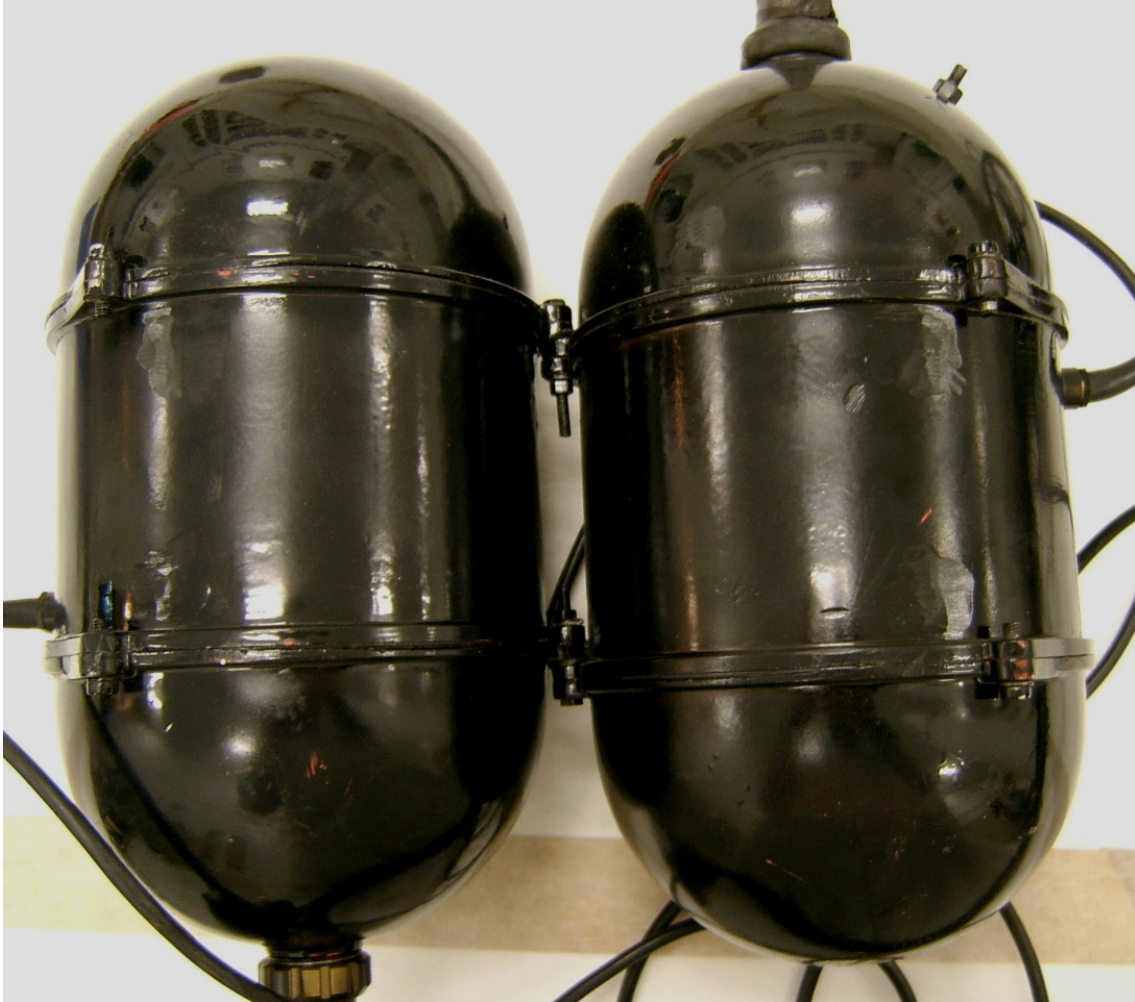
Ilustración 73: Pérdidas y arañazos en la pintura del compresor
