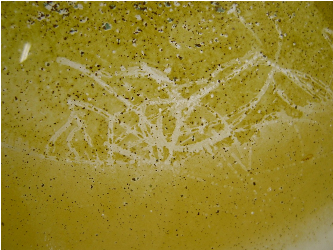
Ilustración 71: Restos depositados de sulfato de cobre en el crisol.
