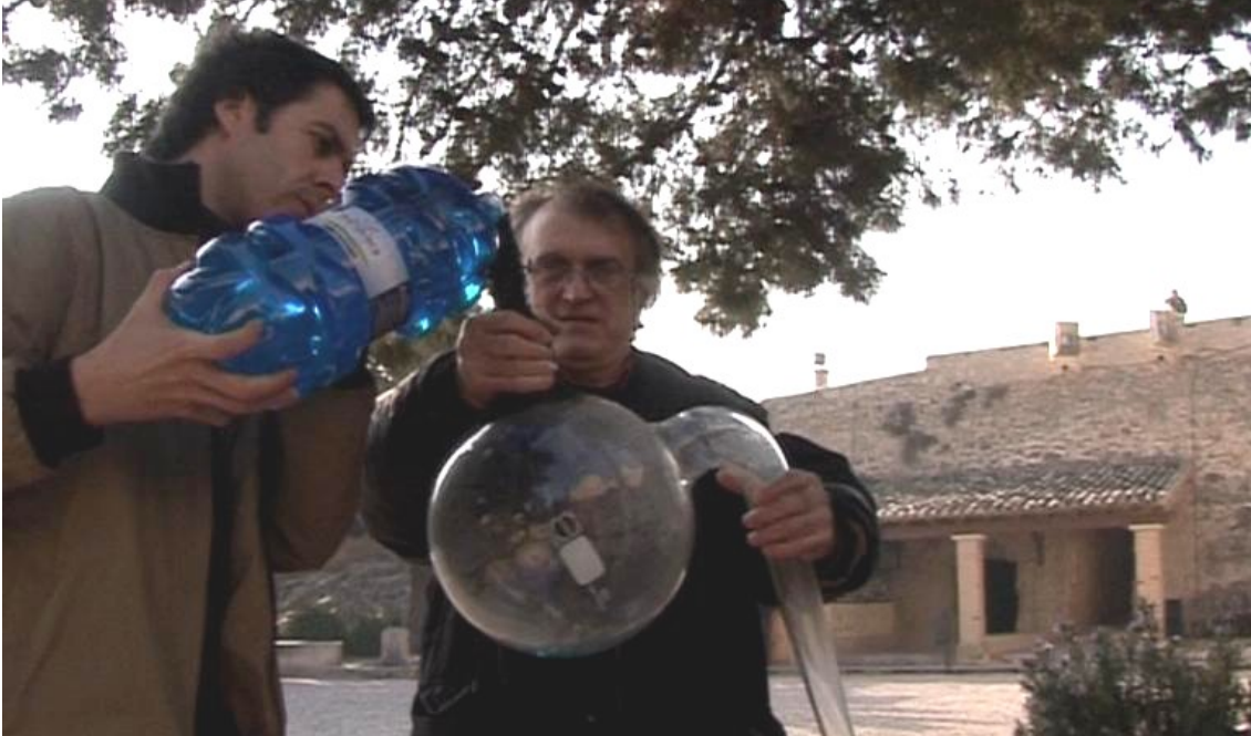
Ilustración 92: Una vez disuelto por saturación el sulfato de cobre en agua, es introducido en el crisol aproximadamente entre un cuarto y un tercio de su volumen
