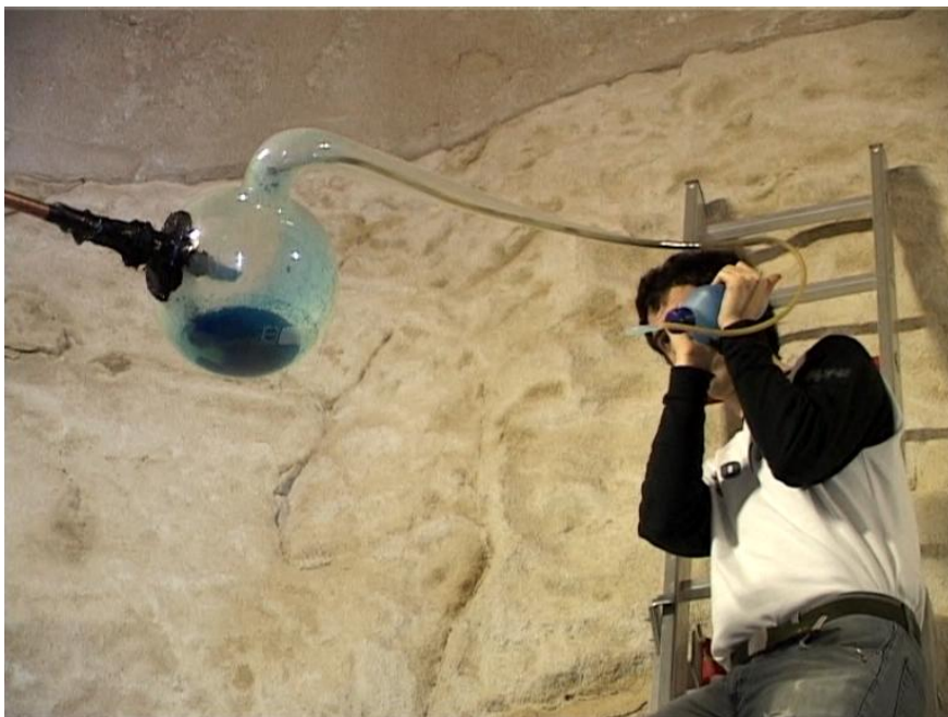
Ilustración 96: Instante en el que se introduce el sulfato de cobre disuelto en agua mediante la ayuda de un gotero de plástico
