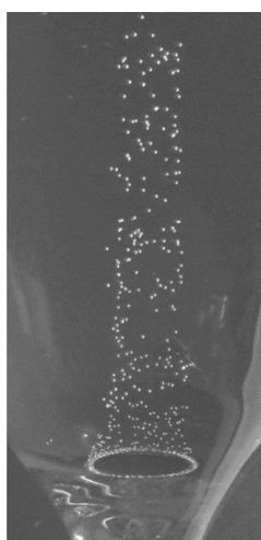
Figura V-33 Nucleación “artificial” generada en microcavidades grabadas con láser en el fondo de una copa (Liger Belair, 2012).
