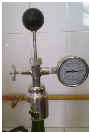
Figura V-1 Medición de la presión con afrómetro que perfora tapa corona.
