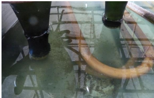
Figura V-4 (a) Baño para congelar picos de las botellas y (b) momento del degüelle para eliminar borras congeladas depositadas en el opérculo.
