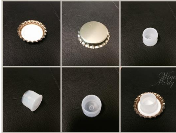
Figura IV-3 Opérculo y tapa corona. Cierre de las botellas de espumante para la segunda fermentación. ( http://winemdg.blogspot.com.ar/2014/08/clinicas-premium-tasting-2014-espumoso.html .)
