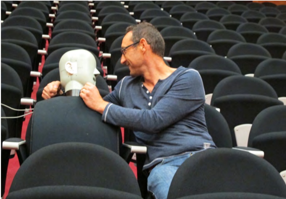
Imagen 3.20. El HATS utilizado en las sesiones de grabación.
