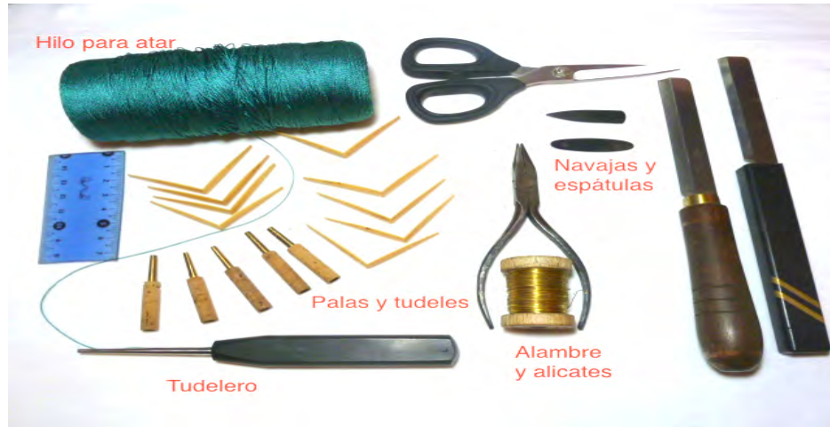
Imagen 3.12. Utensilios necesarios para atar y raspar la caña.
