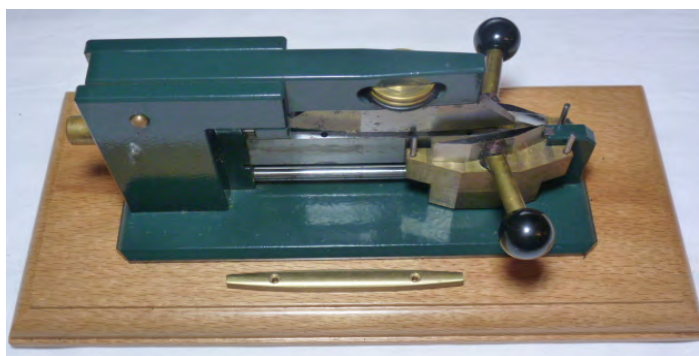
Imagen 3.11. Máquina para dar forma a la pala y forma 69 de Hörtnagel.
