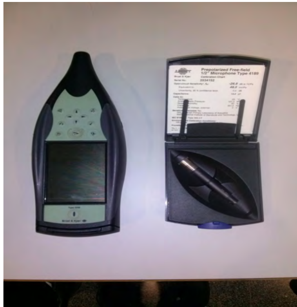
Imagen 3.21. El sonómetro 2250 utilizado en las sesiones de grabación.
