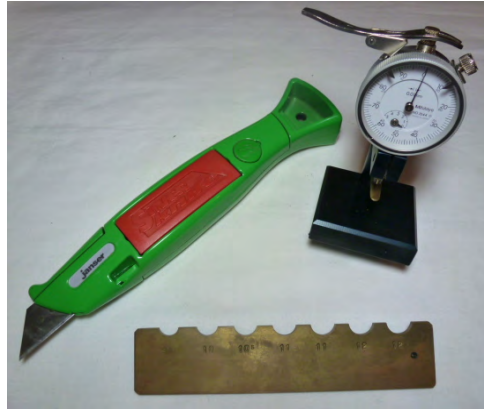
Imagen 3.8. Cúter, micrómetro y medidor de diámetro para los canutos.
