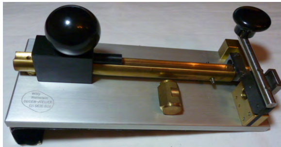
Imagen 3.9. Máquina de pregubia modelo Wettstein.
