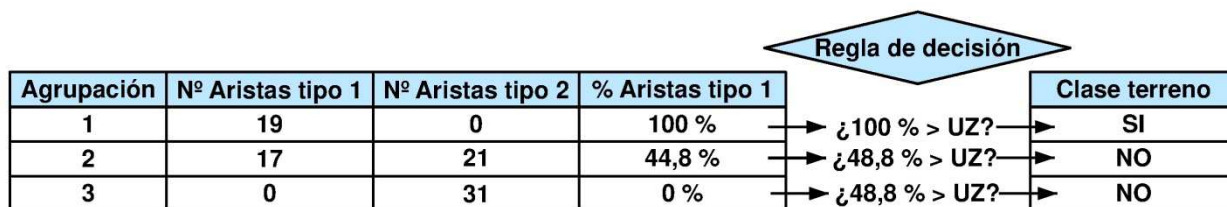
Figura 63. Clasificación de puntos como terreno a partir de umbral en porcentaje de aristas mixtas (tipo 1). Detección del terreno. Algoritmo B.
