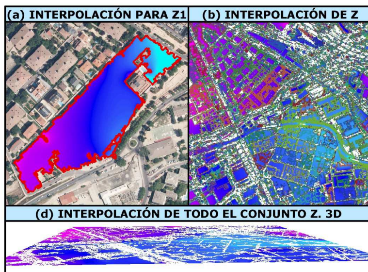
Figura 56. Interpolación selectiva en el proceso de densificación. Detección del terreno. Datos test 2 (Collado Villaba).
