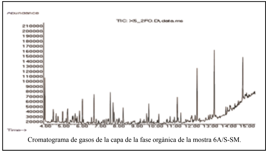
Figura 54. Cromatograma de gasos de la capa de la fase aquosa i orgànica de la mostra 6A/S-SM.
