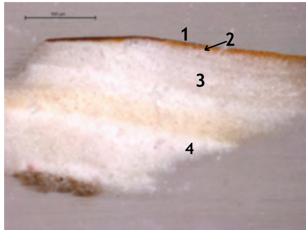
Figura 151. Imatge amb microscopi òptic de la secció transversal de la mostra 16/A-SB. Capa 1: làmina d'or; capa 2: bol; capa 3: preparació carbonat càlcic; capa 4: preparació carbonat càlcic.
