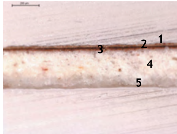
Figura 77. Imatge amb microscopi òptic de la secció transversal de la mostra 8B/S-SU. Capa 1: capa roja. Capa 2: làmina d'or; capa 3: bol; capa 4: preparació guix blanc; capa 5: preparació amb impureses.
