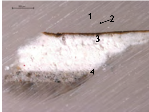
Figura 145. Imatge amb microscopi òptic de la secció transversal de la mostra 15/A-SV. Capa 1: làmina d'or; capa 2: bol; capa 3: preparació guix blanc; capa 4: preparació guix.
