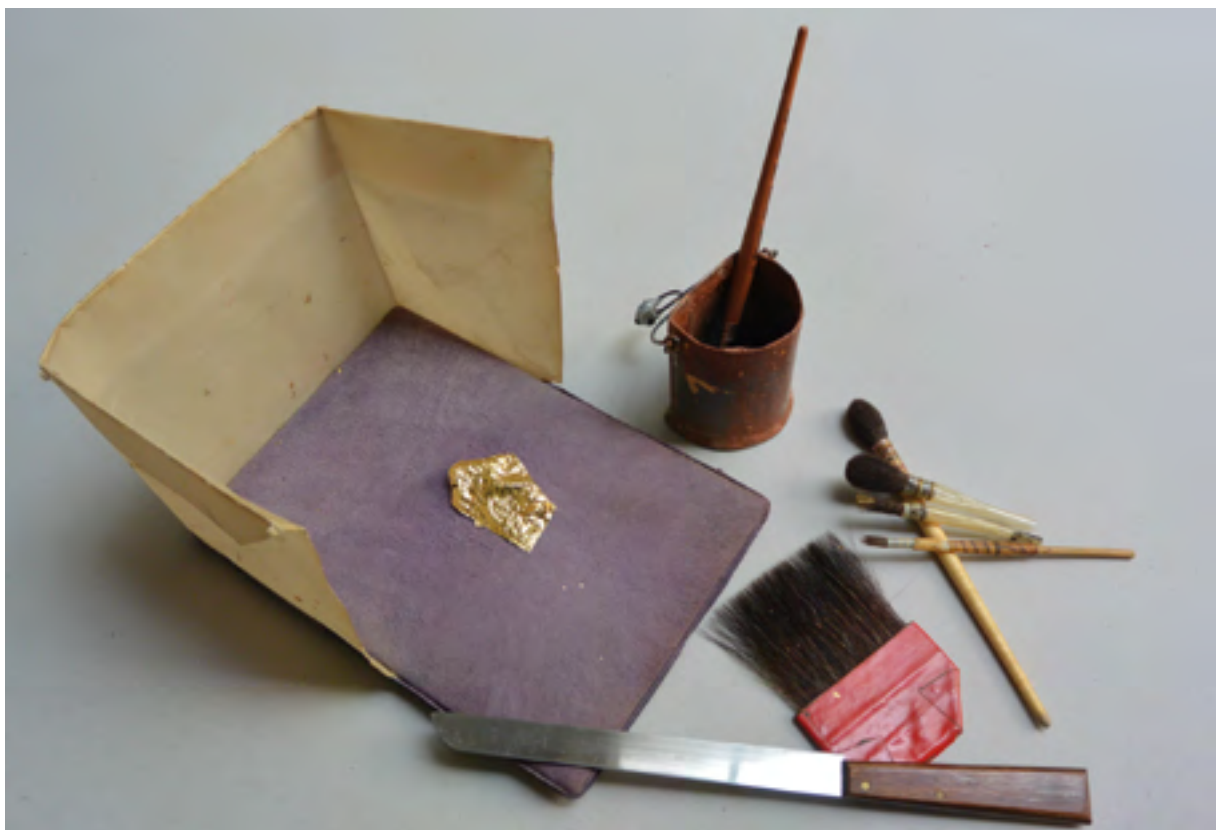
◆ 69. Eines per a daurar: coixinet, ganivet, polonesa, pot, pinzells de banyar i d'aplacar.
