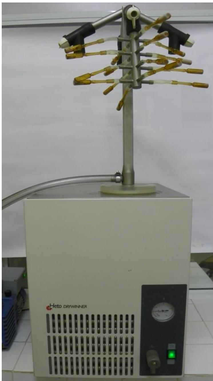
**Figura 6.2** Equipo de liofilización Heto Drywinner provisto de manifold
