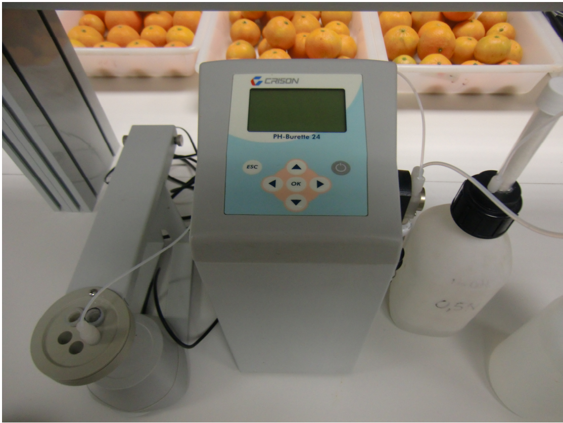
Figura 19. Valorador ácido-base para estimar el índice de madurez en cítricos.
