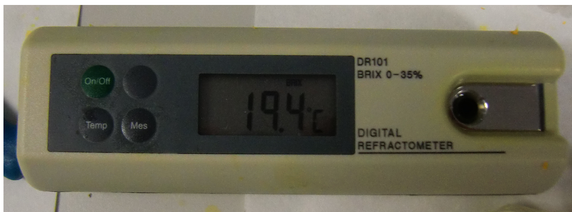
Figura 18. Refractómetro digital utilizado para medir el contenido en azúcares.
