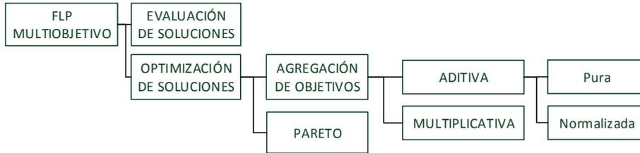
Figura 4 - 2 –Métodos multicriterio para el FLP (Montalva et al. 2012)
