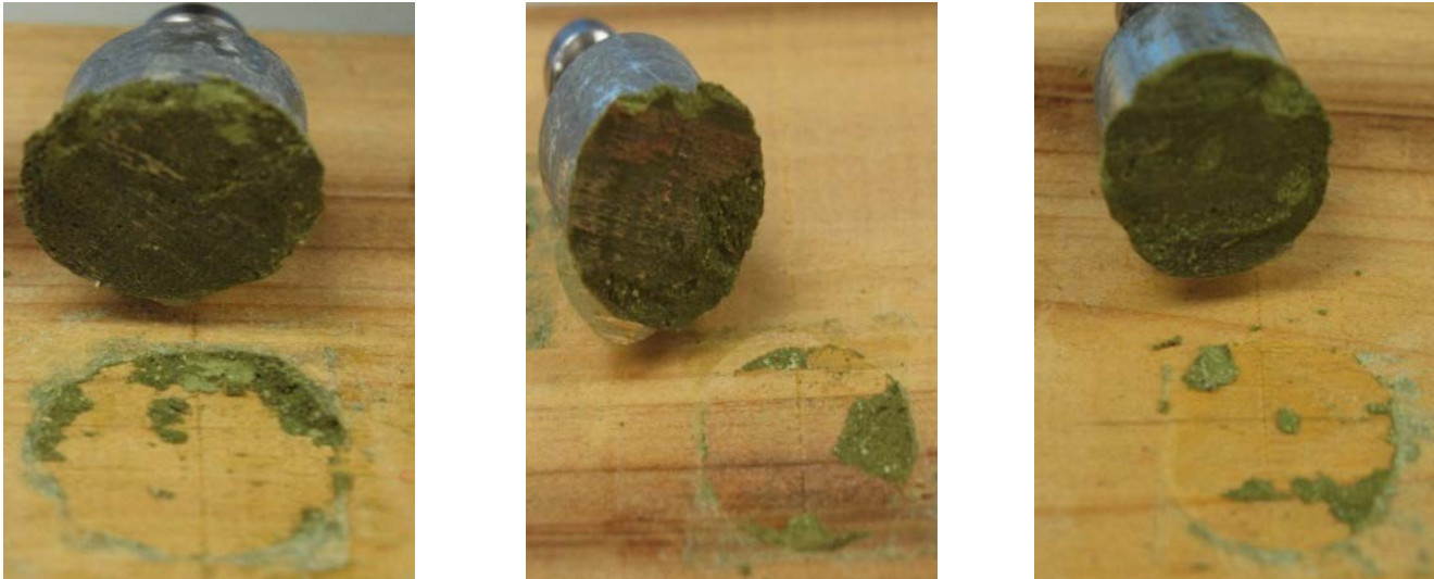
Figura 5.5.22.- Estado de las tres réplicas de probetas adheridas con formulación B1 tras el ensayo de adherencia. La imagen muestra un 80-85% de rotura adhesiva entre la capa de preparación y el soporte de madera.
