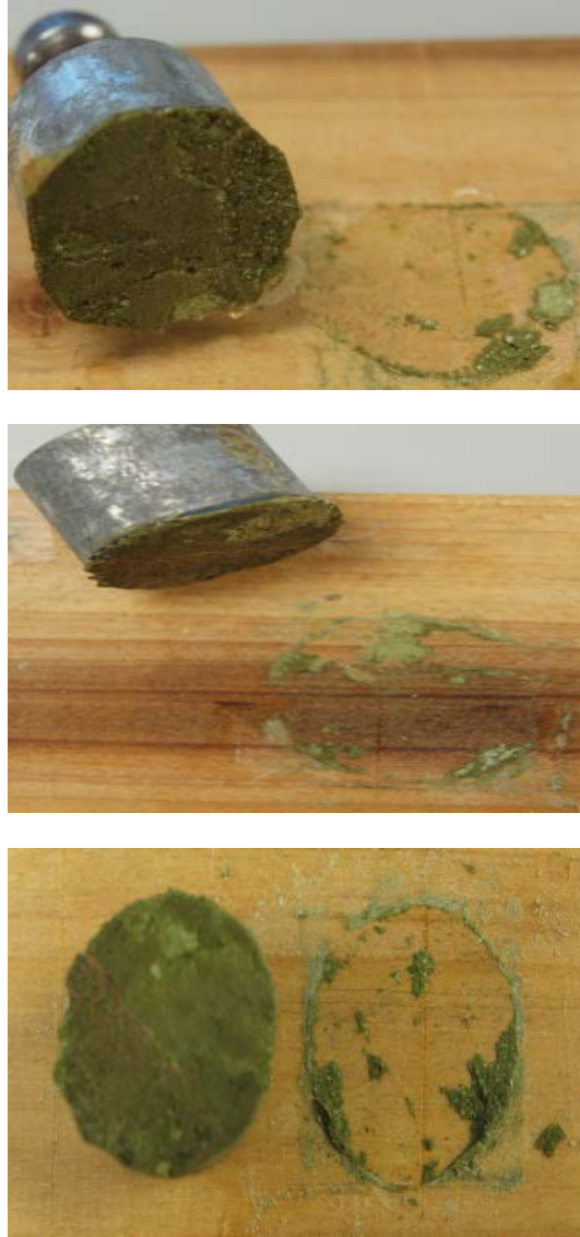
Figura 5.5.21.- Estado de las tres réplicas de probetas adheridas con formulación A2 tras el ensayo de adherencia. La imagen muestra un 80–85% de rotura adhesiva entre la capa de preparación y el soporte de madera.
