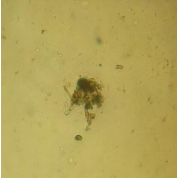
Figura 5.4.55.- Probeta de película ( B2 ) inoculada con esporas de Chaetomium globosum . (izq.) 7 días de incubación; (dcha.) 28 días de incubación. (X25)
