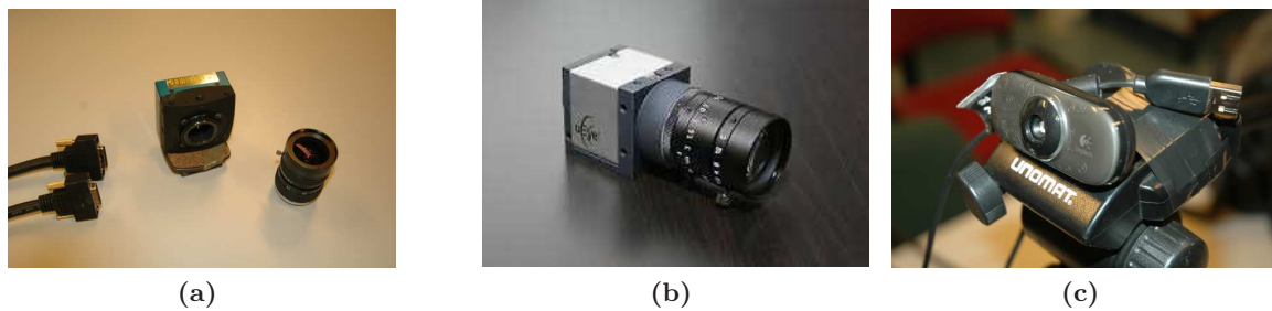
Figura 4.7 – Cámaras utilizadas. (a) Cámara EoSens MC1362 CL , se observan los 2 conectores del interfaz Full Camera Link. También se observa la rosca tipo c y la óptica. (b) Cámara uEye UI-1220-M-BG . (c) Cámara Usb Logitech C210 , se observa el conector USB 2.0 y su reducido tamaño.
