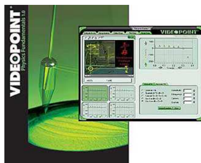
Figura 2.7 – Software de videoanálisis VideoPoint. A partir de la posición en imagen es posible estimar la trayectoria 2D del móvil.
