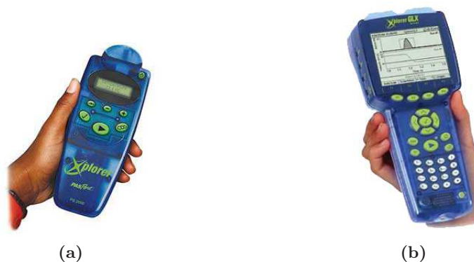
Figura 2.5 – Dispositivos de registro de datos desarrollados por Pasco. (a) Xplorer Datalogger. Este dispositivo permite registrar las variables de un sensor directamente conectado y/o enviar los datos a un PC donde visualizarlos en tiempo real. (b) Xplorer GLX. Puede registrar las señales de hasta 4 sensores simultáneamente e incorpora en el mismo dispositivo 2 sensores de temperatura, 1 de sonido y 1 de voltaje. Permite representar los datos adquiridos en el mismo dispositivo o mandarlos directamente a un memoria externa o a la impresora. Con este dispositivo puede realizarse cualquier experimento sin la necesidad de un PC.
