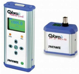
Figura 2.4 – Dispositivo portátil Cobra 4 USB-Link de Phywe que registra variables continuas y las transmite al PC donde son analizadas.
