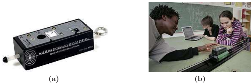
Figura 2.9 – (a) Dispositivo Wireless Dynamics Sensor System , combina un acelerómetro triaxial, un altímetro y un sensor de fuerza en un único dispositivo portátil que se comunica por wireless con el PC, donde los datos son tratados con el software Logger Pro . (b) Ejemplo de práctica para estudiar fuerzas e impactos.
