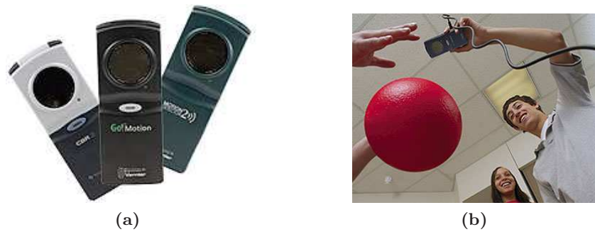
Figura 2.8 – (a) Dispositivo Motion detector . Es un sensor de proximidad por ultrasonidos en un rango de 15 cm a 6 m y pueden conectarse directamente al PC. (b) Ejemplo de uso del dispositivo Motion detection para realizar prácticas de caída libre .
