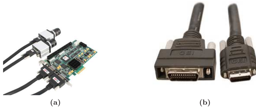
Figura 4.4 – (a) Conexión de cámara con interfaz Camera Link a tarjeta PCI montada en el ordenador. (b) Detalle del conector Camera Link.
