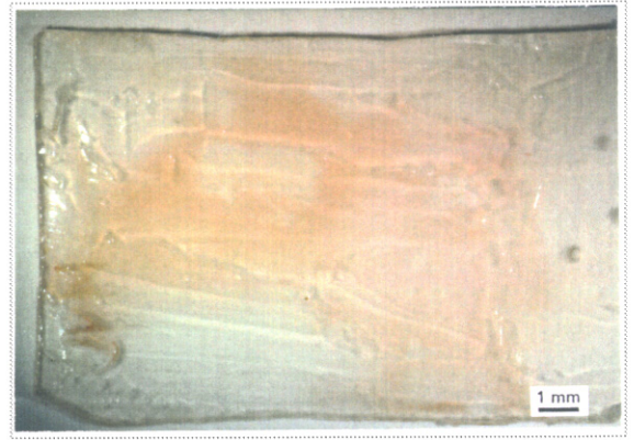
Figura A.18.: Muestra corroída, preparada con Durasil W15 (X10).
