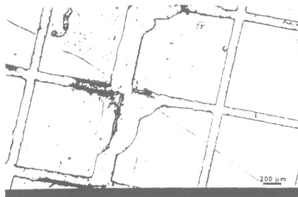
Figura A.58.: Muestra Ref. 4SO preparada con ORMOCER OR G (X50). Evaluada como C2-3.
