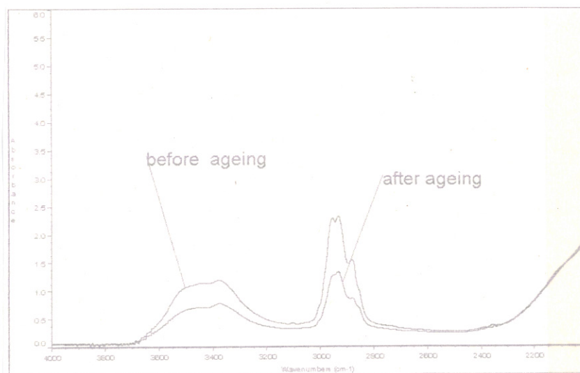
Figura B.14.: Muestra preparada con Vitralit 7515, antes y después de envejecimiento por luz UV.
