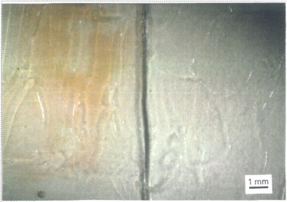
Figura A.23.: Ambas muestras están preparadas con Durasil W15 y envejecidas (X10). Izquierda: muestra corroída; derecha: muestra no corroída.
