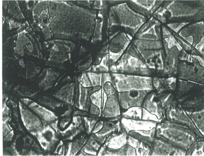
Figura 7.11.: Microfotografía de la superficie de la probeta tipo vidrio modelo, ref. 1MP10. Imagen adquirida después de consolidar con Paraloid B-72 al 10% en tolueno (campo claro; X100). Se observa la penetración del consolidante a través de la red de fracturación.
