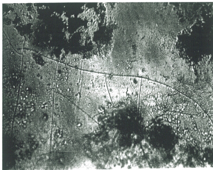
Figura 7.9.: Microfotografía de la superficie del fragmento de vidrio arqueológico Ref. F6II antes de ser consolidado. Tipo de corrosión: microcraquelado de la capa de gel con costra de corrosión superficial. Se aprecia redes de fracturación localizadas en la superficie del vidrio con orientaciones variadas.
