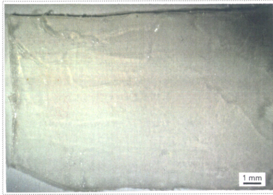
Figura A.17.: Muestra no corroída, preparada con Durasil W15 (X10).
