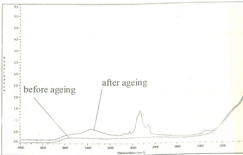
Figura B.4.: Muestra preparada con Desmodur N75 + Viacryl SM564/65, antes y después de envejecimiento térmico.
