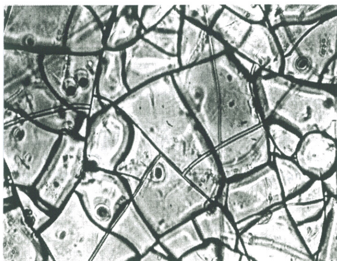
Figura 7.10.: Microfotografía de la superficie de la probeta realizada con vidrio modelo, ref. 1MP10. Se aprecia la red de fracturación provocada por el proceso de corrosión artificial (campo claro; X100). Imagen adquirida antes de realizar la consolidación.
