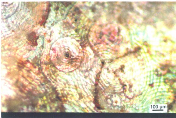
Figura 4.49.: Microfotografía de una zona del fragmento de vidrio Ref. 10a de la calle En Bou, donde se observa la estructura concéntrica de la capa iridiscente. Luz reflejada (X100).
