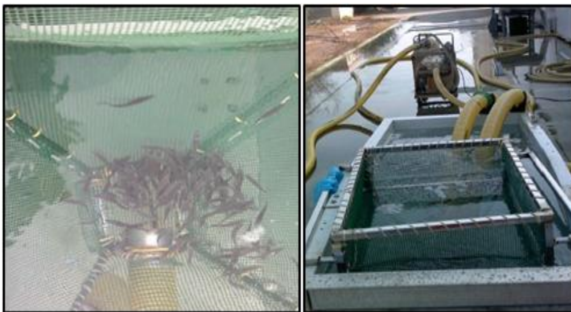
Figura 22: Bomba de succión de peces en operación. *Fuente: Alexandre Garcia Guimarães.
