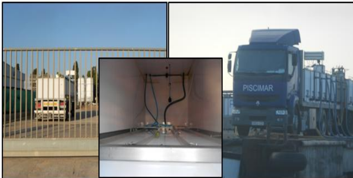
Figura 23: Camiones de transporte y cuba de transporte del camión con sus sondas y difusores de oxígeno. *Fuente: Alexandre Garcia Guimarães.
