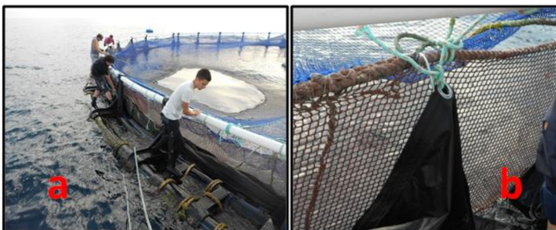
Figura 29: (a) Equipo de superficie tirando de la lona para que esta de la vuelta por completo en la jaula, (b) detalle de como se ata la lona a la barandilla. *Fuente: Alexandre Garcia Guimarães.
