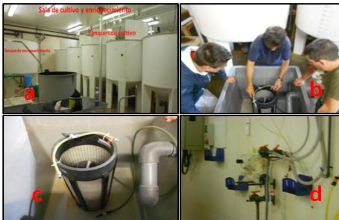
Figura 8: (a) Sala de cultivo y enriquecimiento, (b y c) sistema de cosecha y (d) sistema de bombeo para distribución del rotífero. *Fuente: Alexandre Garcia Guimarães.
