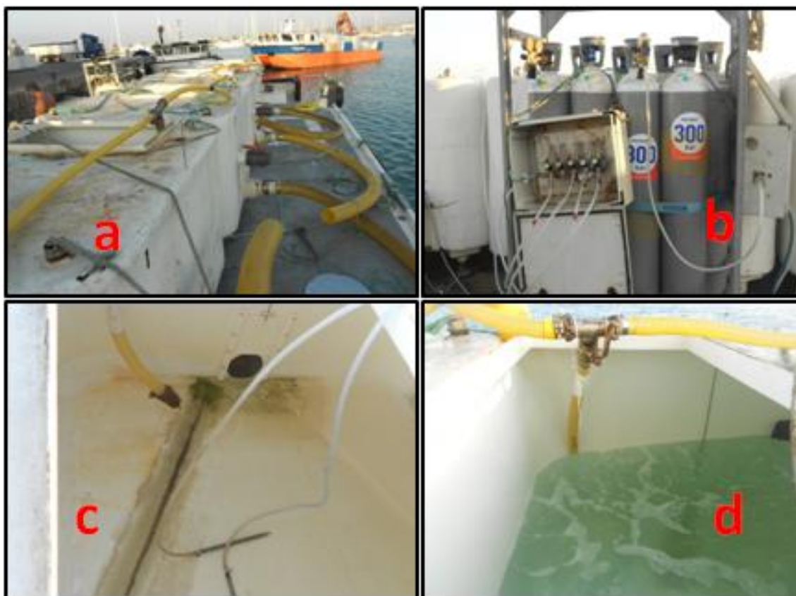
Figura 38: (a) Cubas de 3m 3 cada una en la cubierta del barco, (b) cuadro de control de oxígeno, (c) detalle de los difusores de oxígeno dentro de la cuba, (d) cubas llenas de agua del mar. *Fuente: Alexandre Garcia Guimarães.
