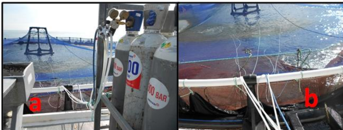
Figura 30: (a) Bombonas de oxígeno, (b) mangueras con los difusores de oxígeno. *Fuente: Alexandre Garcia Guimarães.
