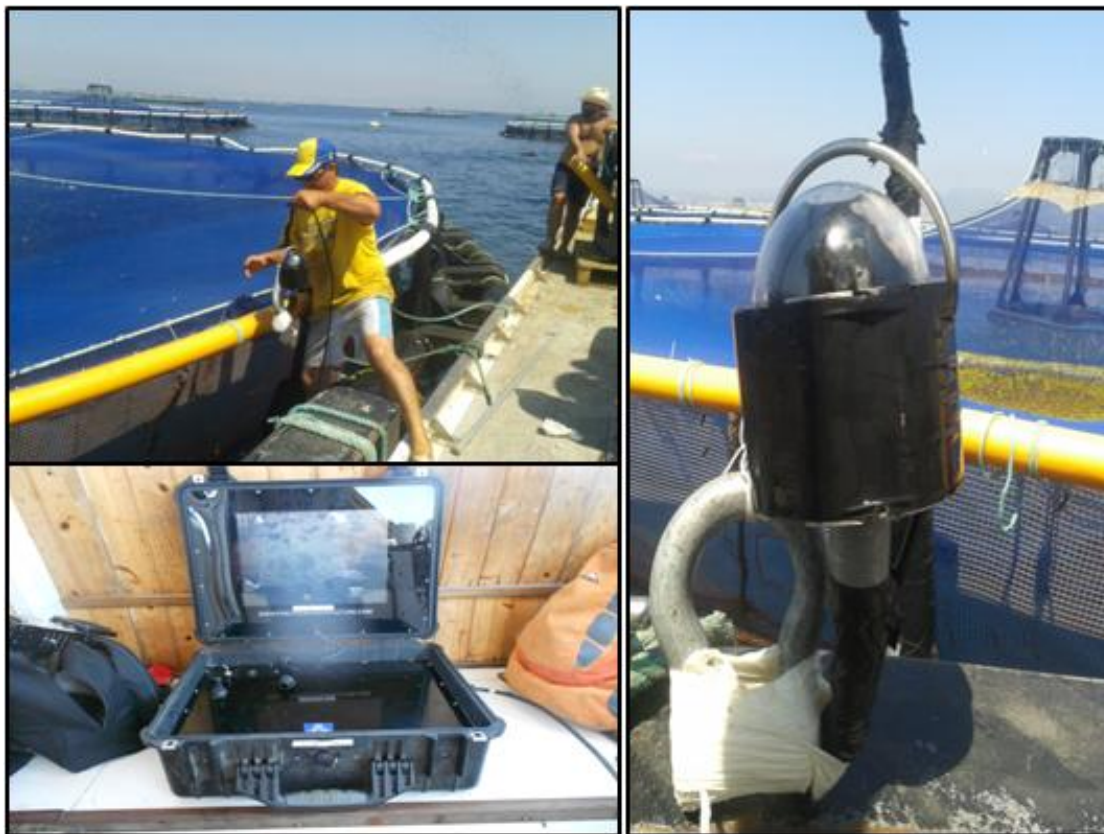
Figura 48: Sistema de video cámaras para monitoreo de la alimentación. *Fuente: Alexandre Garcia Guimarães.
