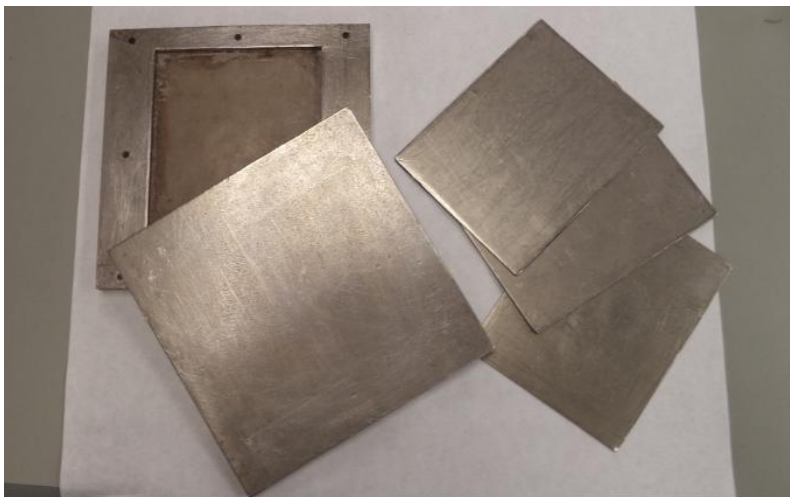
*Figura 2.4: Molde de compresión simple y placas de diferentes espesores.
