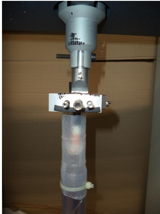
*Figura 2.13: Fijación de conducto de silicona de diámetro interior 30mm y globo simple a la máquina de tracción "Adamel".
