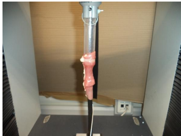
*Figura 2.14: Intestino y globo simple fijados a máquina de tracción “Adamel”.
