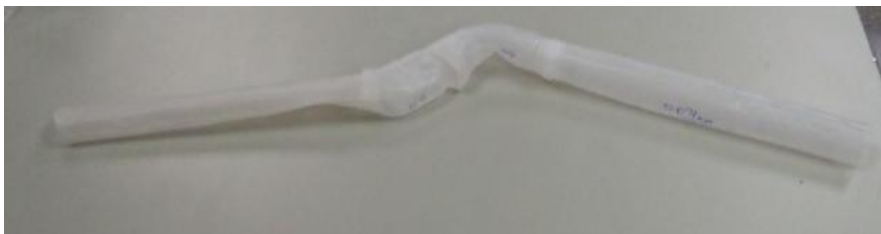
*Figura 3.1: Intestino de silicona de 0,4 mm de espesor.
