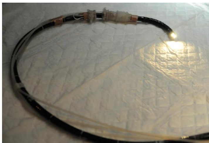
*Figura 1.1: Dispositivo “EndoWorm” adaptado a un endoscopio convencional.
