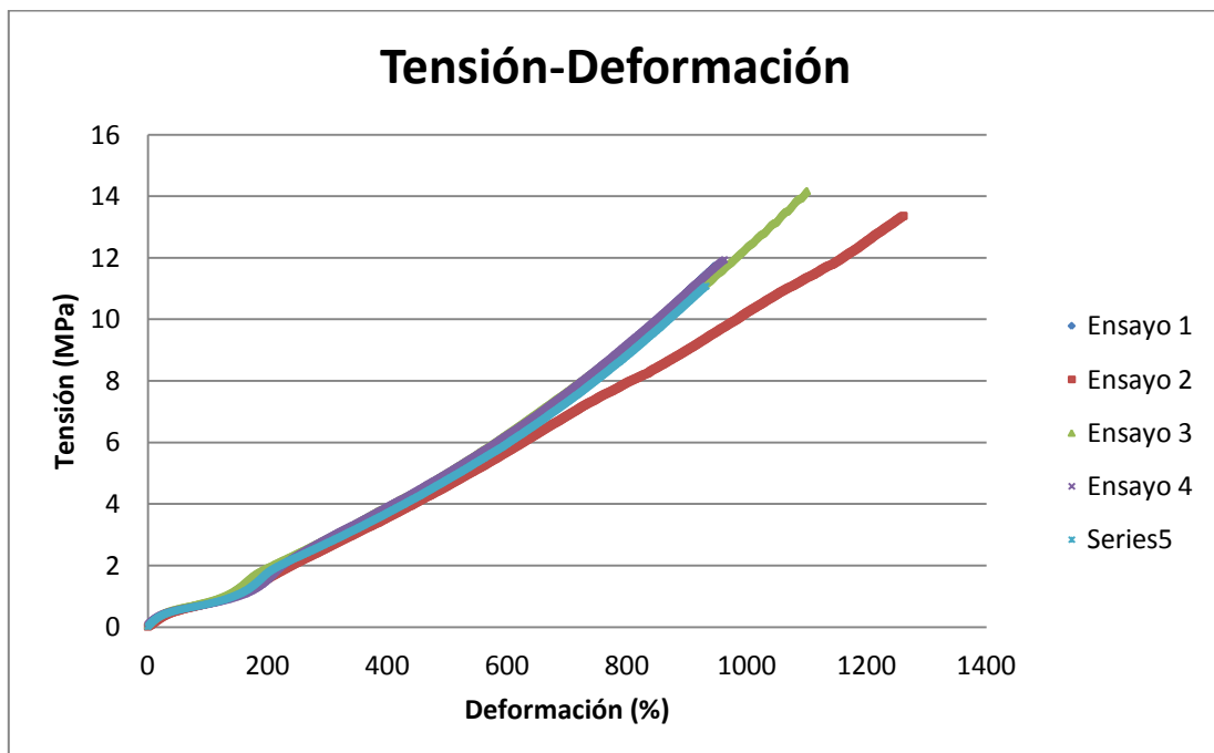
*Figura 3.29: Curva Tensión-Deformación de Halterios de silicona Silastic Q7-4720 fatigados (N=6000).
