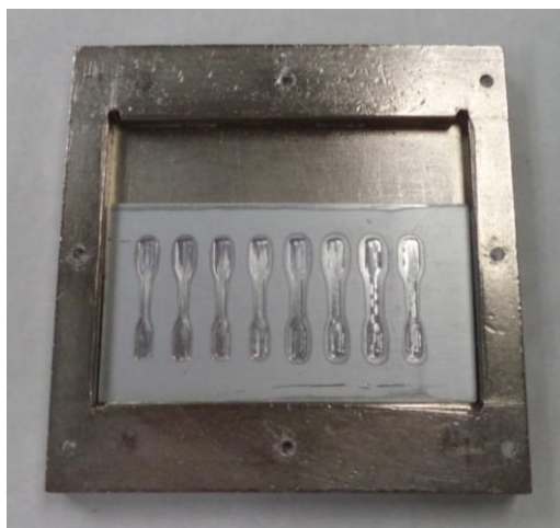
*Figura 2.9: Molde de aluminio dentro de “molde de compresión simple”.
