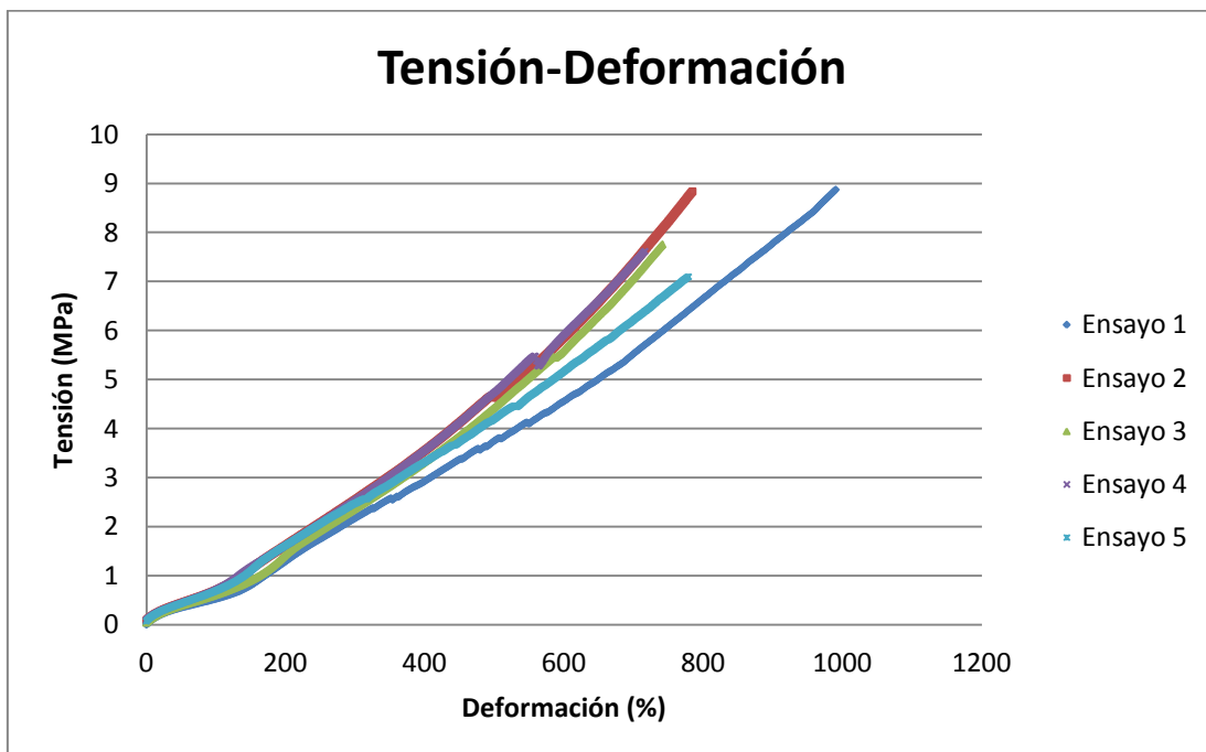
*Figura 3.23: Curva Tensión-Deformación de Halterios de silicona Silastic 7-6830 sin fatigar.
