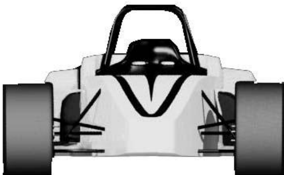
Imagen 29. Suspensiones añadidas en modelo.
