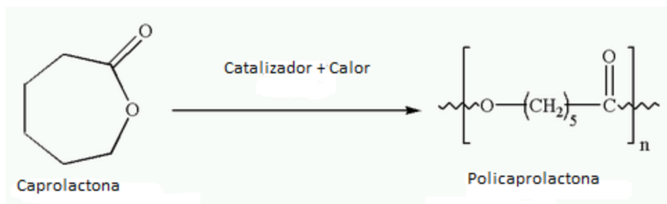
Figura 2.3. Obtención de la Policaprolactona (PCL)
