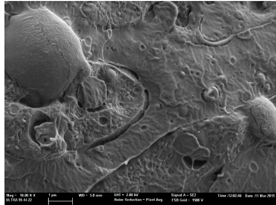
Figura 5.25 Imagen PLA60% + PCL 30% + TPS 10% a 10000 aumentos
