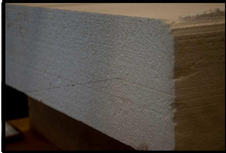
Una vez obtenidas las dimensiones del cuadrado se metió en la fresadora del taller. Se colocó unas gomas con las dimensiones aproximadas del cuadrado de poliespan, las cuales, sirven para inmovilizar la pieza a través del vacío.
