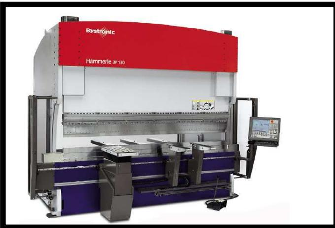
Las prensas plegadoras son máquinas utilizadas para el trabajo en frío de materiales generalmente chapas.
