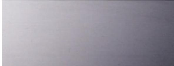
Esta superficie, menos rugosa que la anterior, se logra con el material laminado en frío, recocido y decapado. La apariencia mate de la superficie, poco reflectante, la hace adecuada para aplicaciones industriales y de ingeniería aunque, en arquitectura es menos usada
