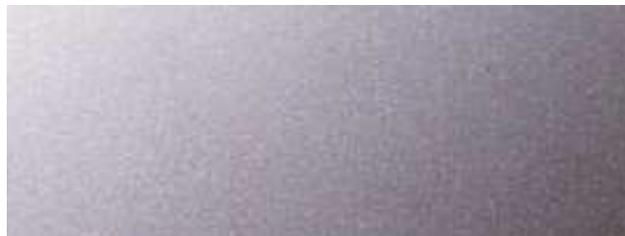
Es un acabado con grabado (se obtienen laminando las bobinas con rodillos previamente grabados con dibujo, este proceso sirve para endurecer la chapa y permite espesores más finos), tiene un acabado mate de escaso reflejo en los lados de la chapa. El material ha sido decapado y pasado con rodillos de dibujos.
