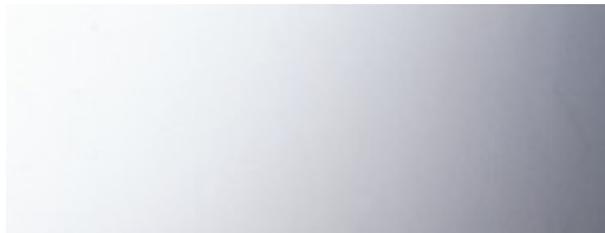
Producido mediante el mismo proceso de la anterior superficie, con un ligero laminado final utilizando un rodillo muy pulido que proporciona una superficie lisa, reflectante, grisácea. Es el acabado superficial más utilizado en la actualidad y sirve de base para la mayoría de acabados brillantes y pulidos.
