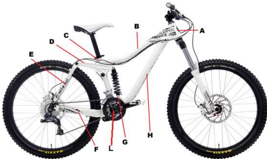
Figura 5. Componentes de un cuadro de Enduro modelo "Kona stinky TI"
