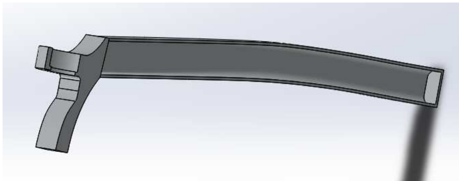
Figura 56. Operación de vaciado barra tirante
