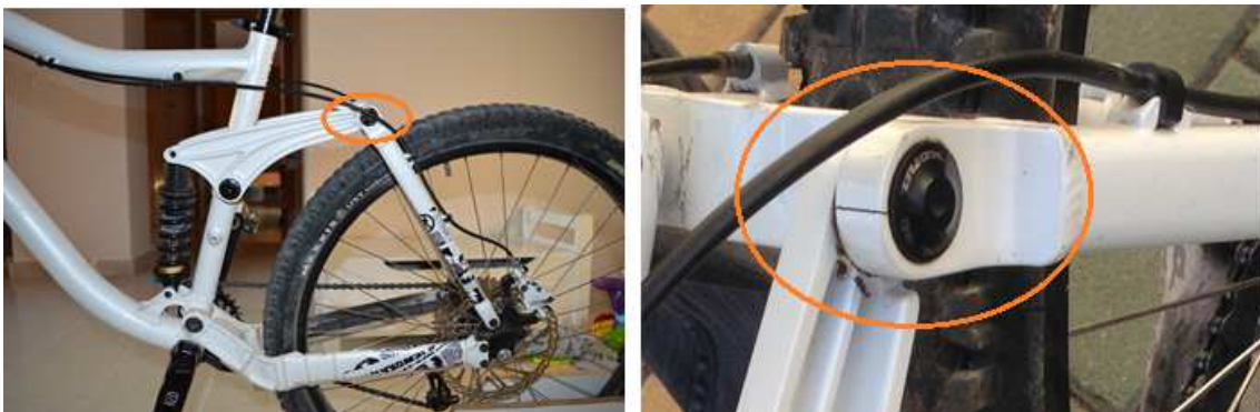
Figura 23. Falla del tirante posterior
