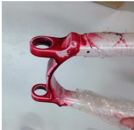
Figura 25. Aplicación de líquido penetrante
