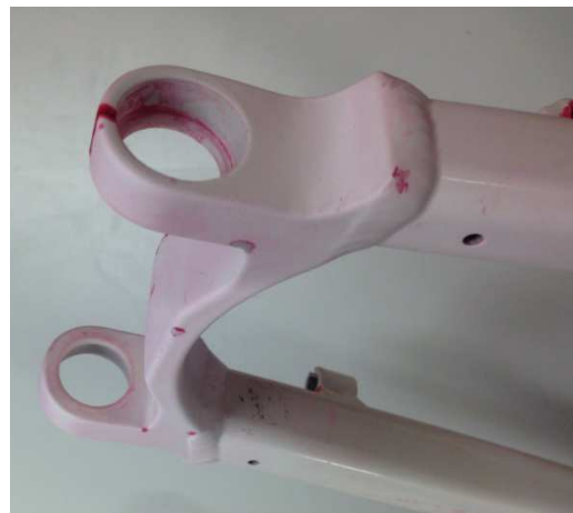
Figura 27. Aplicación del revelador.
