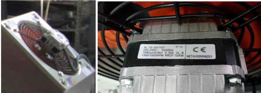
La cámara de refrigeración: Formada por chapas de acero inoxidable AISI-304 de 1.5mm de grosor, diseñada para redirigir el aire hacia la pastilla de forma deseada.
