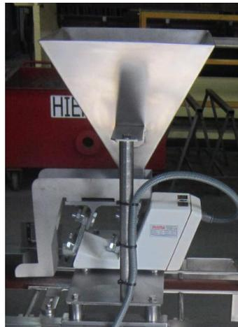
Tambi3n se compone con unos vibradores TARNOS modelo FT-02, encargado de realizar la dosificaci3n mediante la vibraci3n transmitida.
