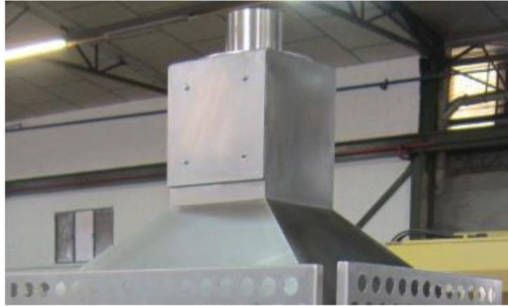
**Extractor:** modelo CMP-718-4T/R, el conjunto está diseñado para evacuar cualquier humo ocasionado por el tueste.
