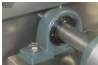
Soporte tensor: Tendremos un soporte para el tensor de la rueda conducida y su chapa protectora, para poder garantizar la tensi3n apropiada de la cinta y la seguridad de posibles riegos.
