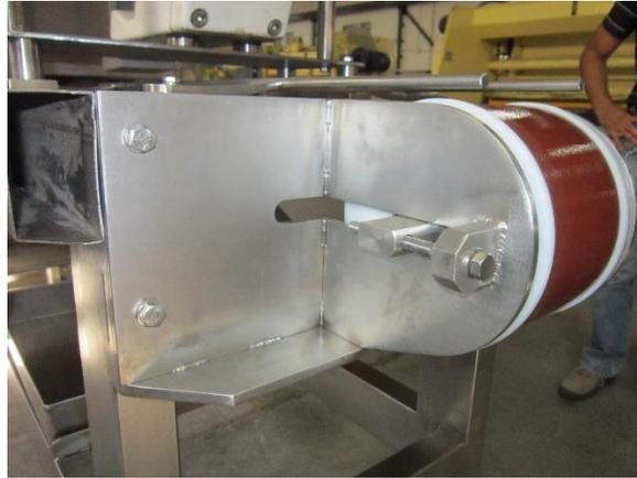
Guías para pastillas: Para un buen guiado de las pastillas hemos diseado unas guías de pastillas de geometría circular de acero inoxidable AISI-304, con un  $\varnothing 7\text{mm}$ .
