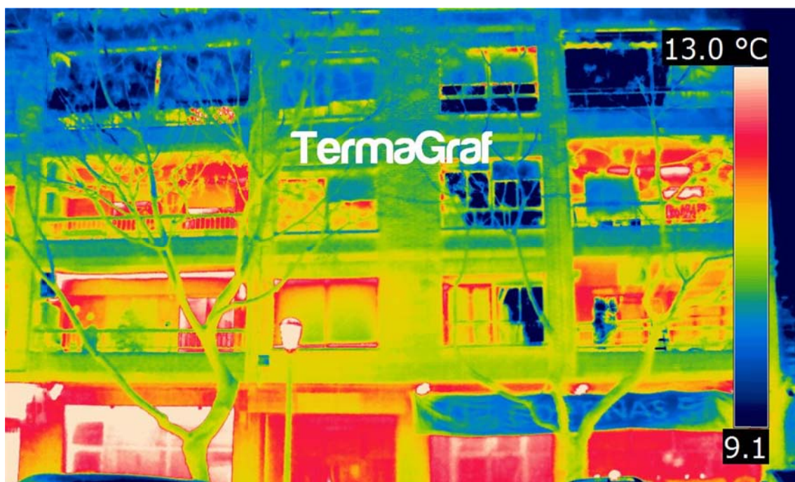
Imagen 31: Termografías de la fachada principal del edificio Fuente IVE
