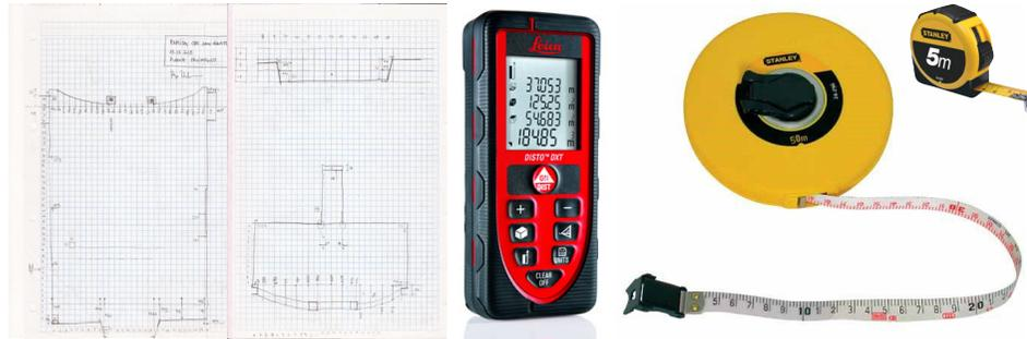
Fig. 21 - Croquis de la planta de la ermita y equipo utilizado para realizar el levantamiento planimétrico.
