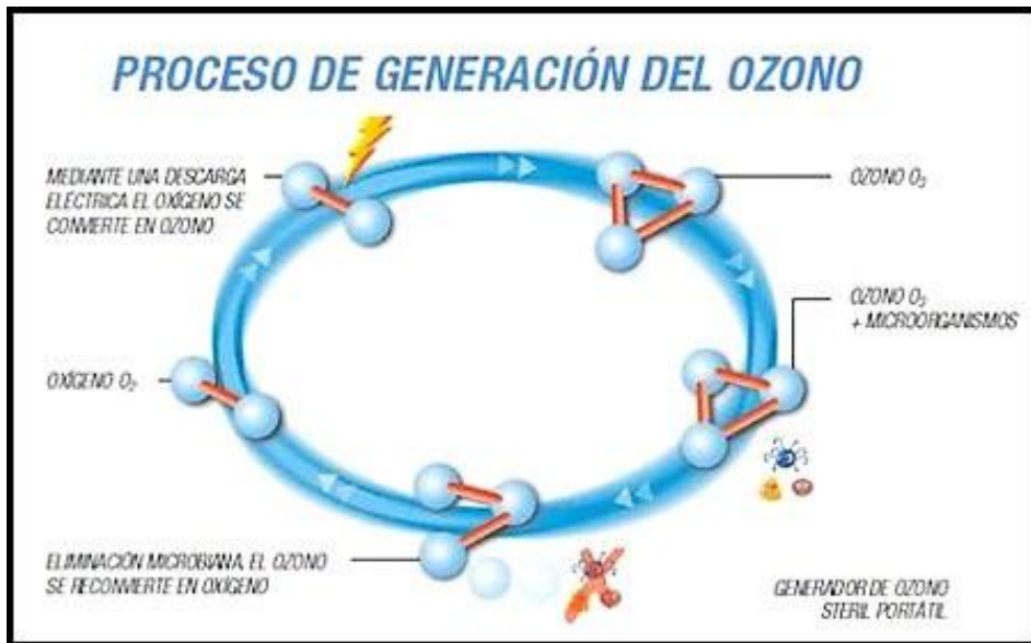
Ilustración 42.- Proceso de generación del ozono (Fernández Troyano, 2014).
