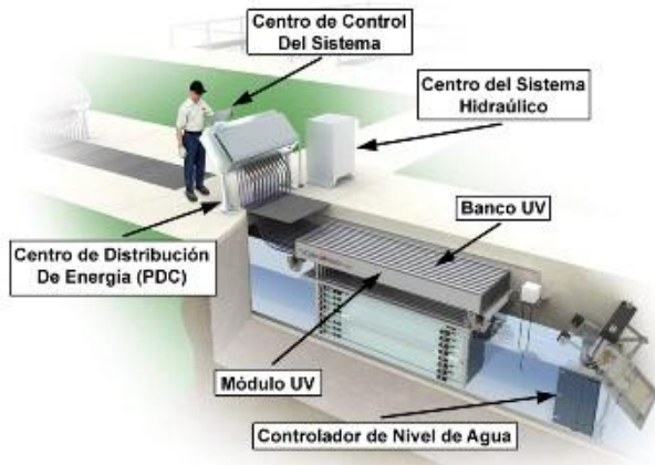
Ilustración 44.- Esquema de un reactor UV.
