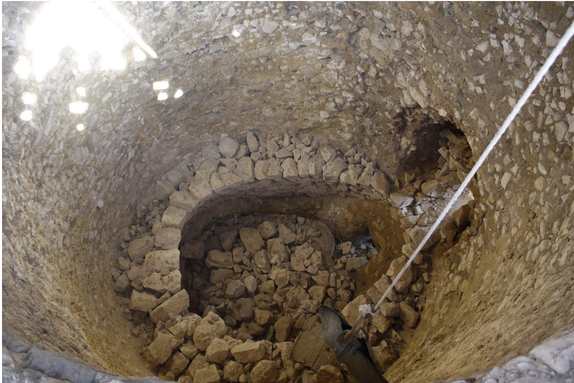
Fig. 22. Majada de roca caliza en el proceso de llenado del horno. Museo cal de Morón.
