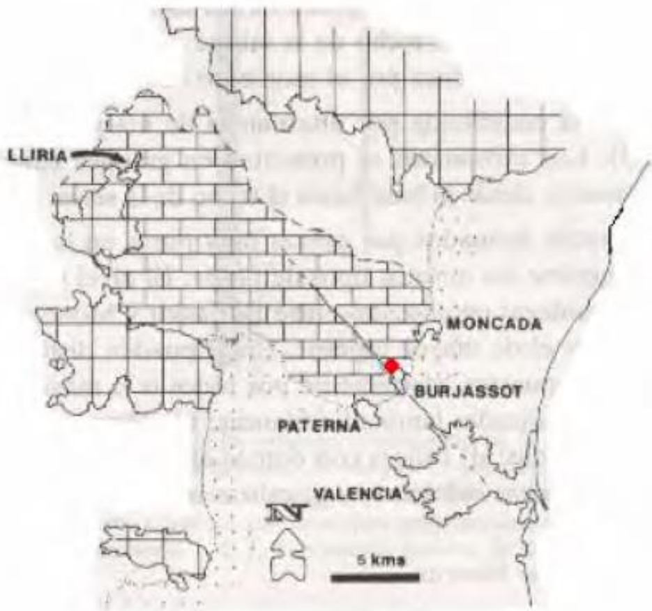
Fig. 76. Esquema cartográfico de la cuenca de Valencia-Lliria. Cuadrilado: substrato Mesozoico. Enladrillado: calizas lacustres del Mioceno Superior. Punteado: depósitos Fuente: Santisteban, C. de, J. Brito y J. Usera (1988)
