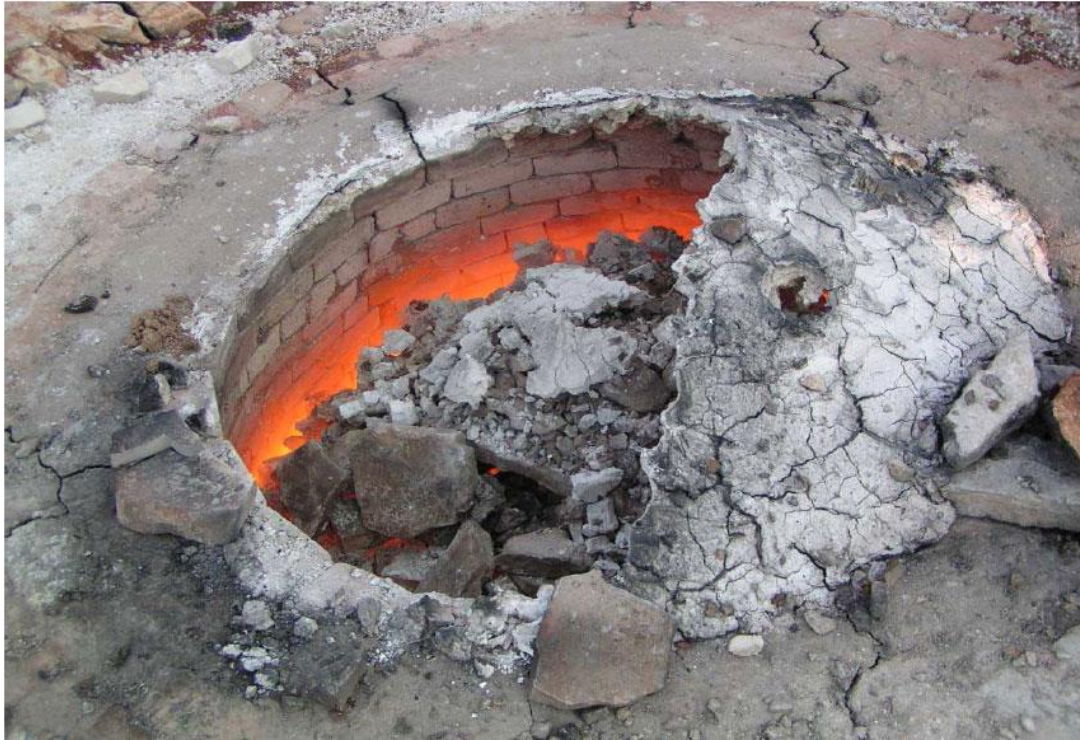
Fig. 24. Fase final de calcinación final de horno de cal.
