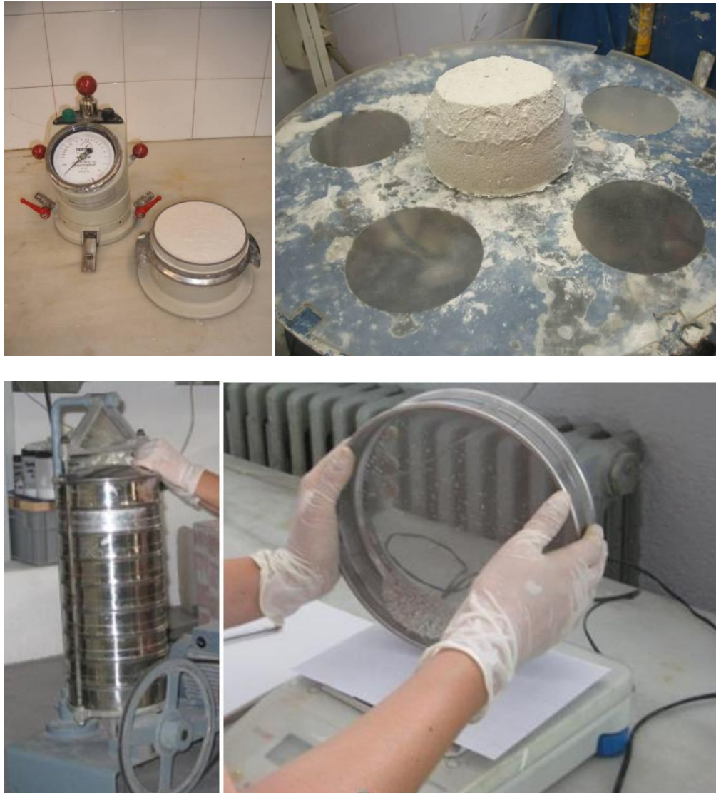
Fig. 37. Ensayos morteros fresco. Cantidad de aire ocluido, agua de amasado y consistencia, densidad y ensayo granulométrico.
