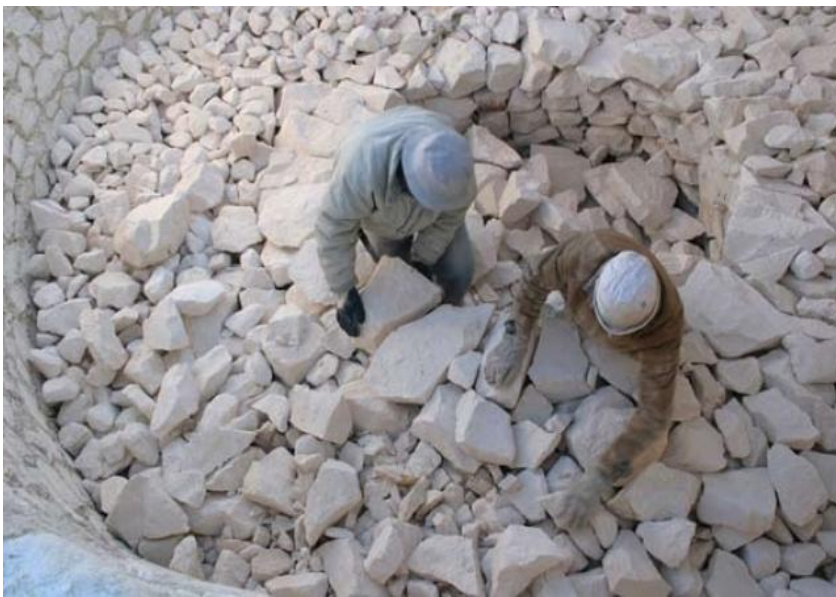
Fig. 26. Colocación de las piedras calizas, en el proceso de llenado del horno.
