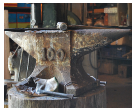
5.8 y 5.9. Yunque formado tan solo por el cuerpo central (arriba), o por el cuerpo central y las bigornias cónica y piramidal (abajo).
