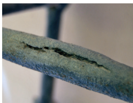
5.33. Oxidación de hierro por efecto de los agentes atmosféricos (izquierda).
