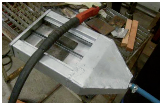
Figura 1: Dispositivo para la soldadura TIG con cámara inerte
