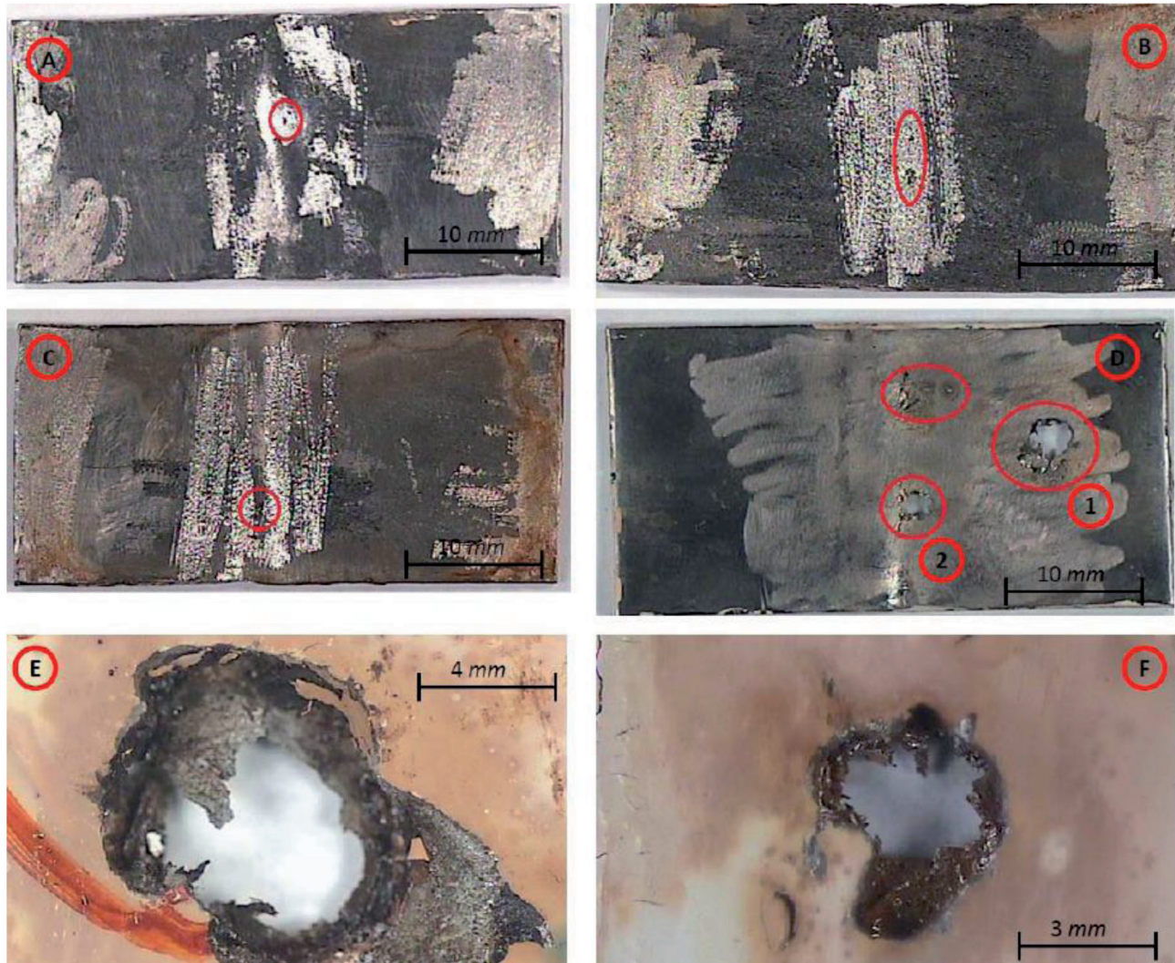
Figura 5: Imágenes de las probetas 304 con aporte INCONEL 625 con atmósfera inerte de argón en ensayo de corrosión por picaduras: A) Probeta sin radiación; B) Probeta con radiación a 200 Gy; C) Probeta con radiación a 700 Gy; D) Probeta con radiación a 1000 Gy; E) Ampliación de defecto 1 en imagen D; F) Ampliación de defecto 2 en imagen D.
