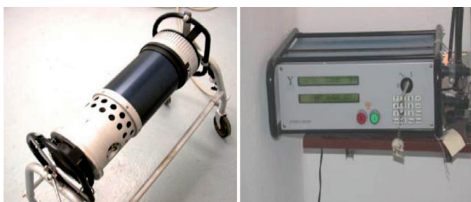
Figura 3: Aparato de rayos X y sistema de control de dosis de radiación
