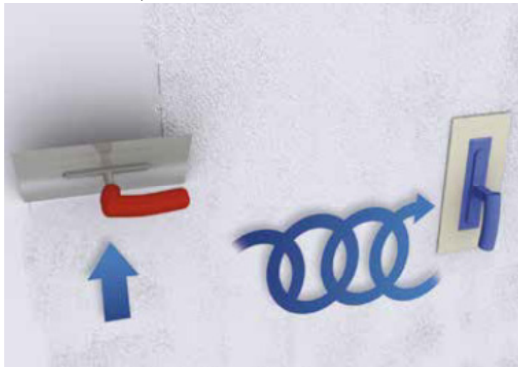
Terminación con talocha de plástico
