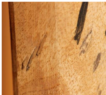
Imagen 71: Macrofotografía de detalle. Descamación reverso.
