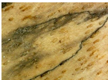
Imagen 59: Macrofotografía soporte. Detalle de los vasos leñosos. Realizada con Cooling Tech ®
