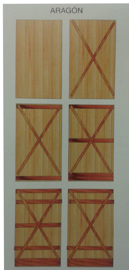
Fig.9 Travesaños zona de Aragón
