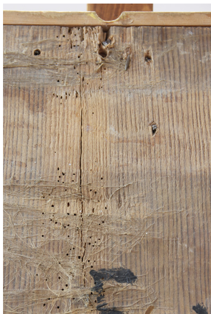
Fig.25 Detalle de zona astillada, faltantes y ataque de insectos xilófagos.
