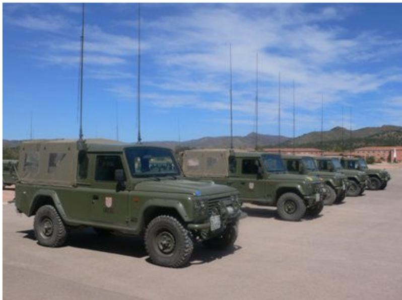
**Figura 116: Vehículos Aníbal con antenas para PR4G V3**
