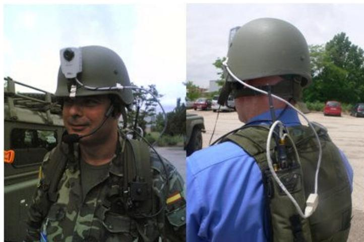
**Figura 100: Sistema completo con cámara y radio Spearnet**
