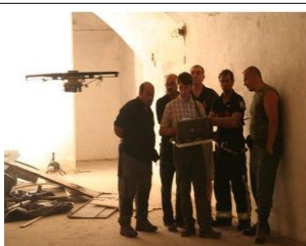
**Figura 110: UAV con cámara para la inspección de túneles**
