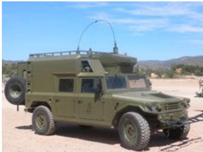
**Figura 119: Vehículo de comunicaciones Mercurio con antena NVIS (Near Vertical Incident Skywave) para medios radio HF**
