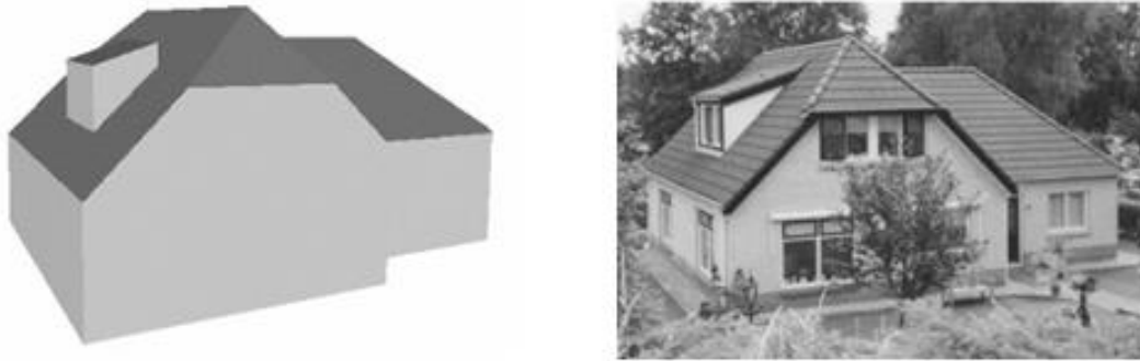
Ilustración 10: Reconstrucción conseguida por [43] utilizando la transformada de Hough.
